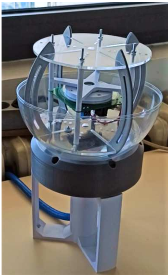
Slika 3.14: Prikaz ADCS sustava sa pripadajućim zračnim ležajem.
