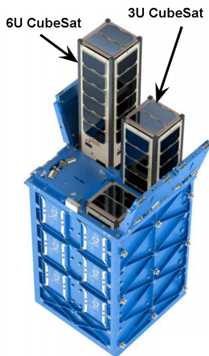
Slika 1.3: Lansirni kavez Cubesat satelita [15].
