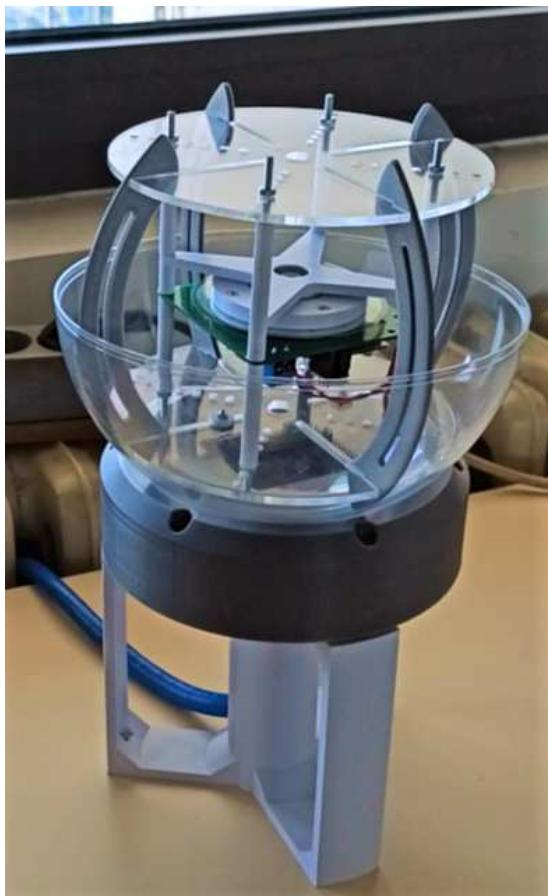
Slika 3.14: Prikaz ADCS sustava sa pripadajućim zračnim ležajem.
