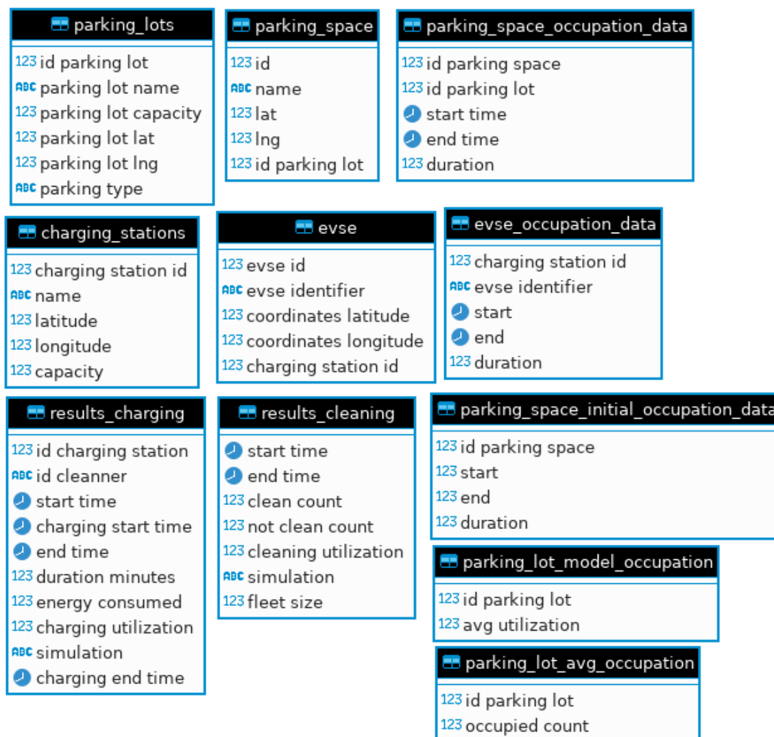
Slika 5.15: Prikaz dijagrama relacija baze podataka korištene u platformi za simulaciju transportnog sustava flote električnih vozila
