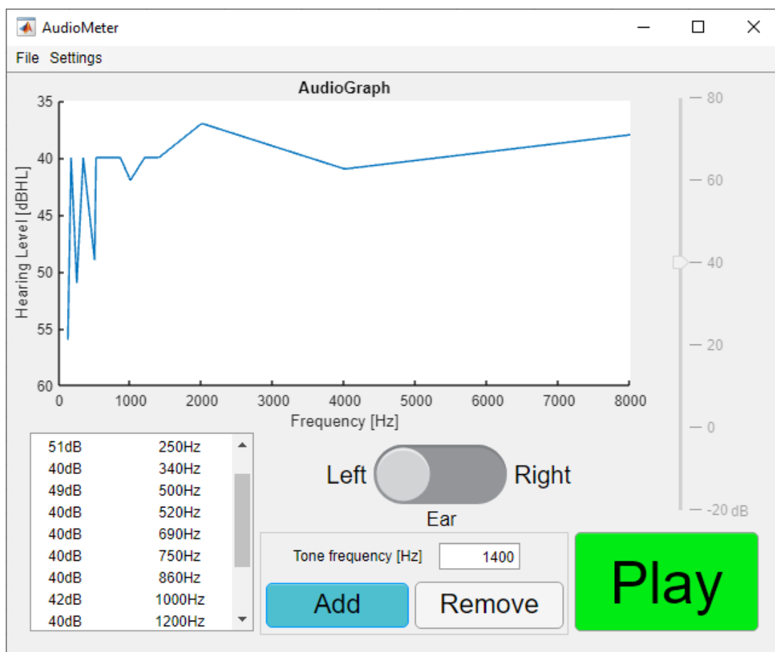
Slika 3.1: Sučelje računalnog programa za tonsku audiometriju veće razlučivosti
