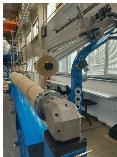
(c) namatanje glavne izolacije
