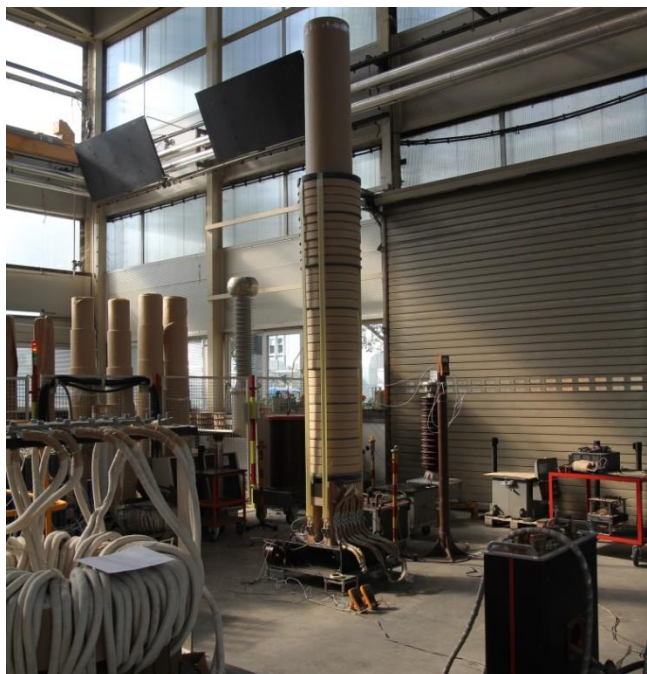
Slika 22. (a) Shematski prikaz mjernog kruga ispitivanja s promjenjivim teretom (b) Fotografija mjernog kruga u laboratoriju
