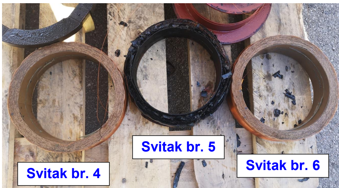
Slika 36. Usporedba oštećenja na petom svitku sa zdravim četvrtim i šestim svitkom
