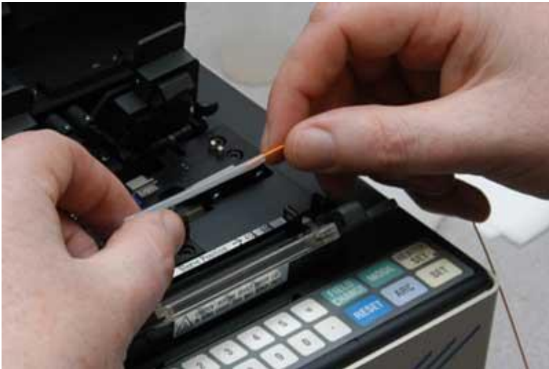
Slika 3.7. Spajanje optičkog kabela postupkom zavarivanja [2]
