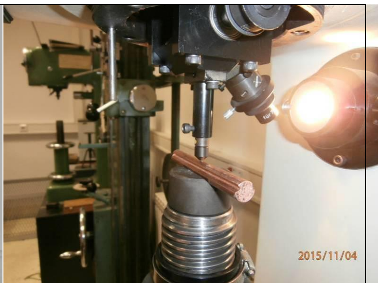
Slika 7.18. Mjerenje tvrdoće površine
