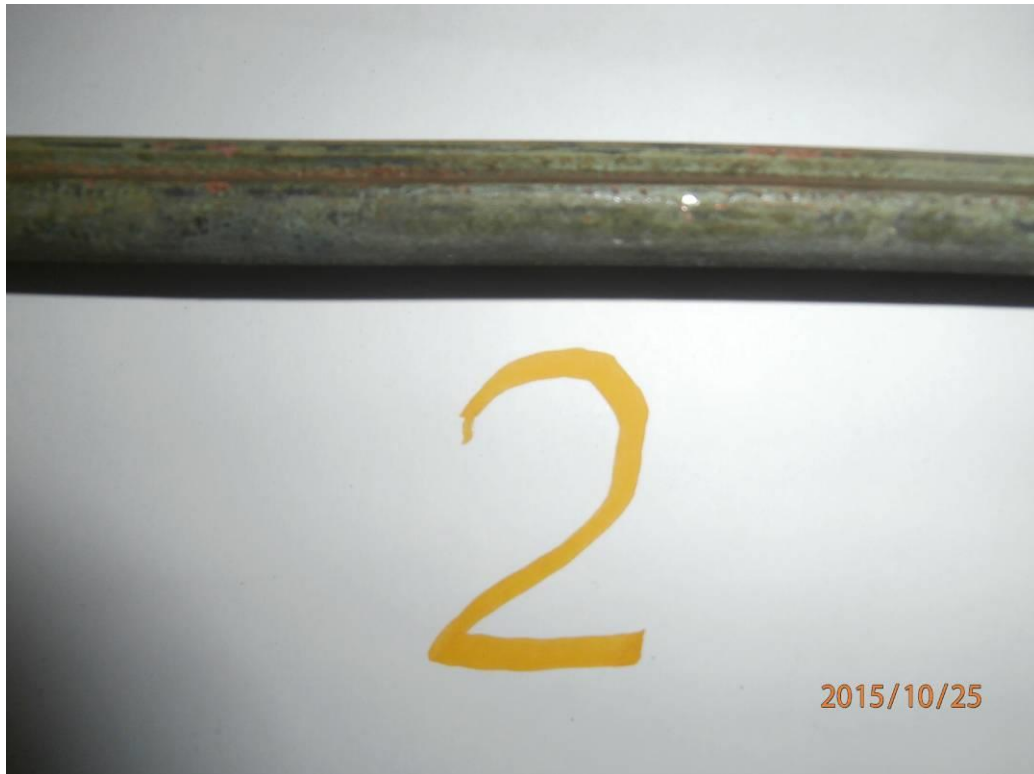
Slika 7.4. Uzorak 2 – neaktivni dio eksploatiranog vodiča
