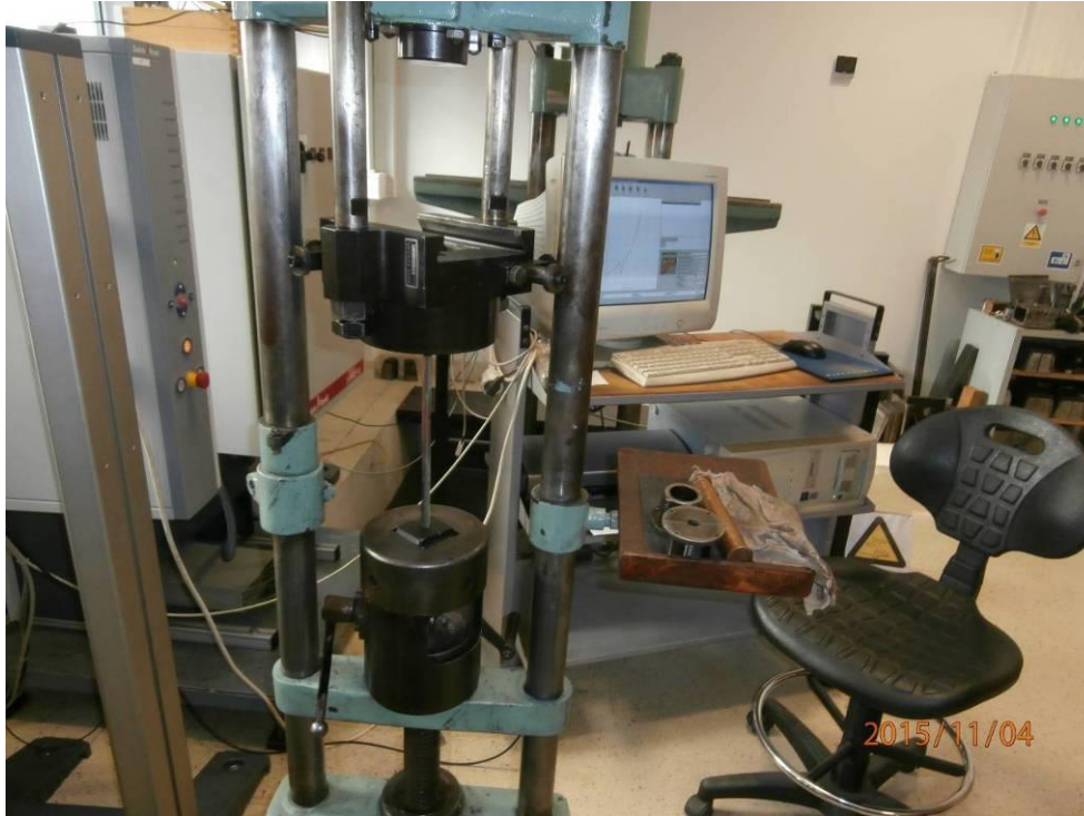
Slika 7.12. Kidalica za ispitivanje na vlak
