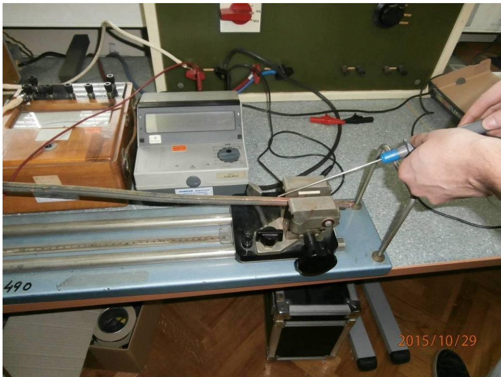
Slika 7.7 Ispitivanje električne vodljivosti
