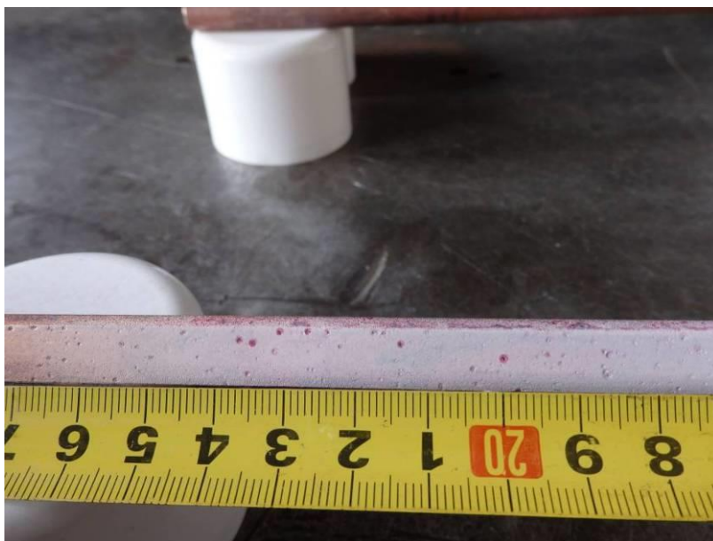
Slika 7.23. Nanesen razvijač na uzorak 1
