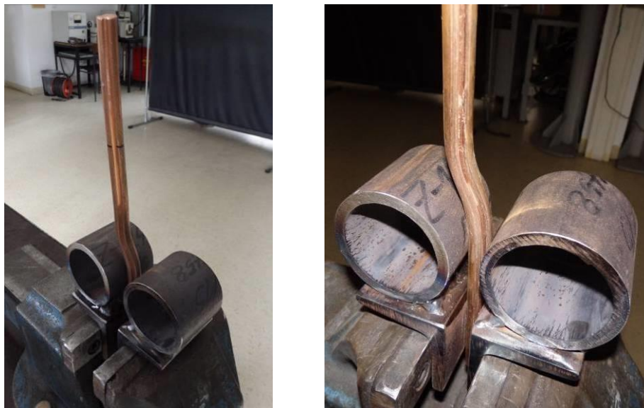
Slika 7.20. Uzorak u napravi za vrijeme ispitivanja previjanjem
