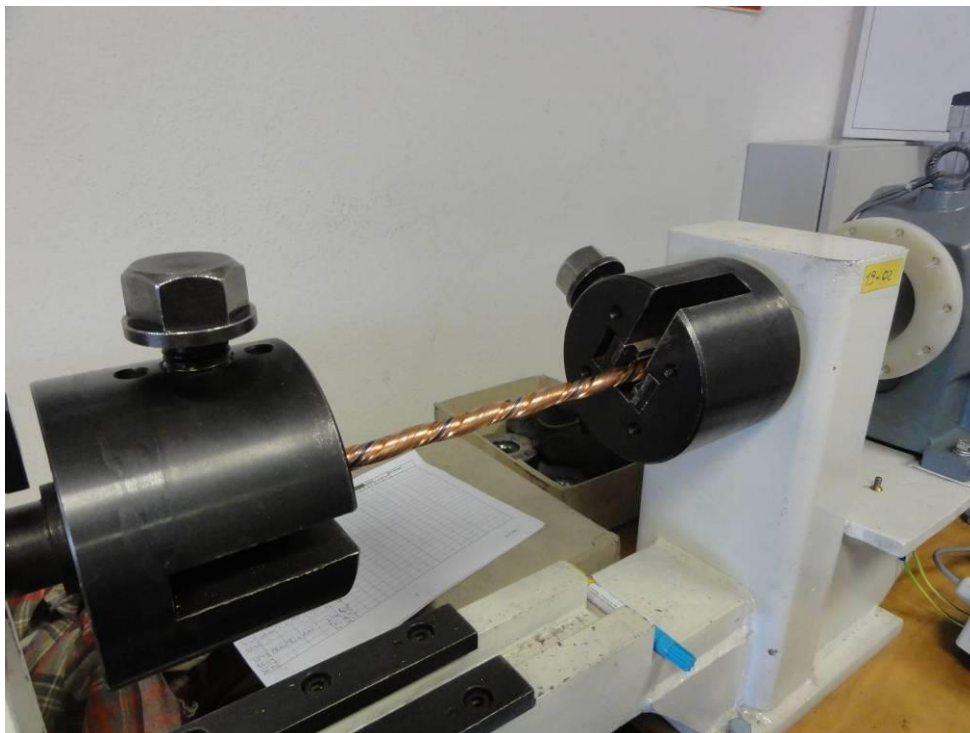
Slika 4.5. Ispitivanje na torziju
