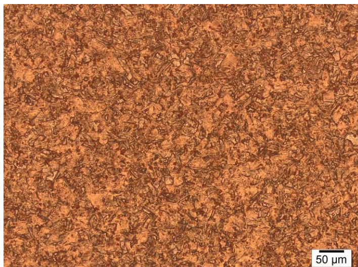
Slika 7.35. Uzorak U-3 - Mikrografija iz sredine poprečnog presjeka. Veličina zrna prema ASTM E112 je cca 9
