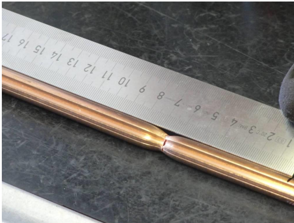
Slika 4.2. Mjerenje postotka istezanja na puknutom uzorku
