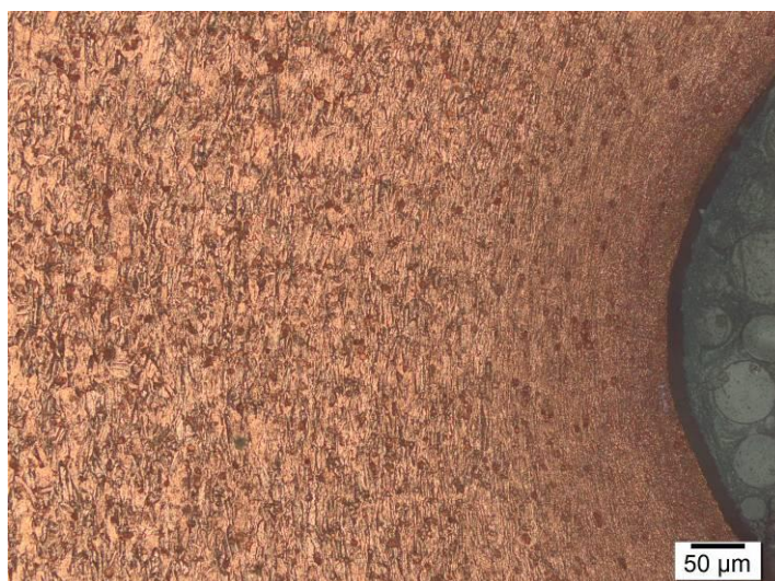
Slika 7.36. Uzorak U-3 - Ugnječena struktura u utoru profila
