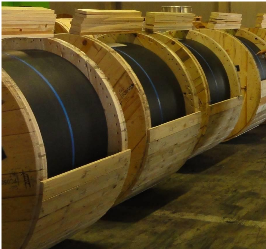
Slika 4.1. Bubnjevi kontaktnog vodiča
