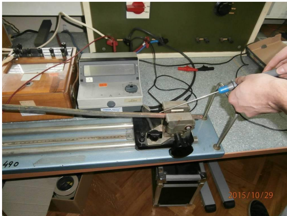
Slika 7.7 Ispitivanje električne vodljivosti
