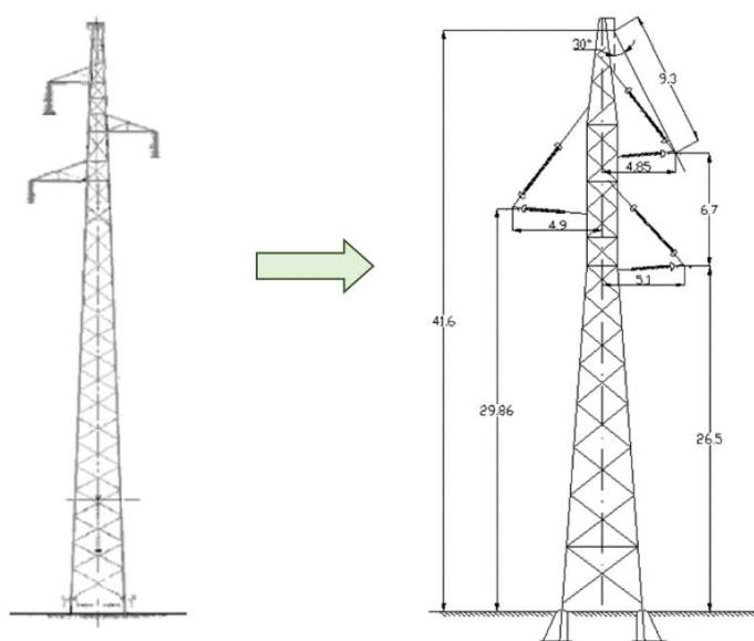
Slika 7.2: Geometrija postojećeg 220 kV i predloženog kompaktiranog 400 kV stupa
