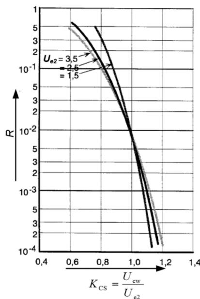
Slika 6.9: Rizik probaja izolacije pri sklopnim prenaponima u ovisnosti o statističkom koordinacijskom faktoru (“phase to phase” metoda) [84]
