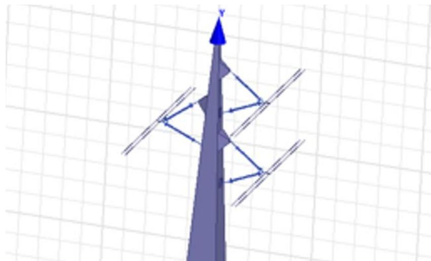
Slika 7.17: Konfiguracija izolatorskog V lanca kompaktiranog dalekovoda
