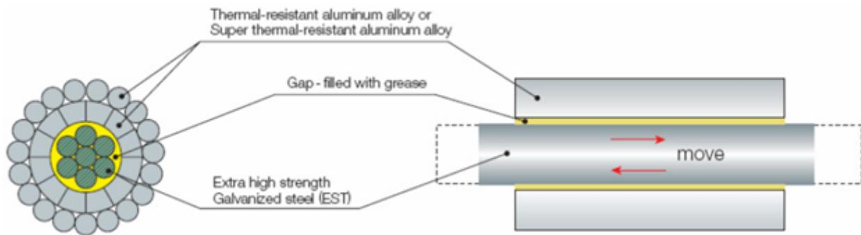
Slika 2.6: Prikaza GTAACSR konstrukcije vodiča [57]
