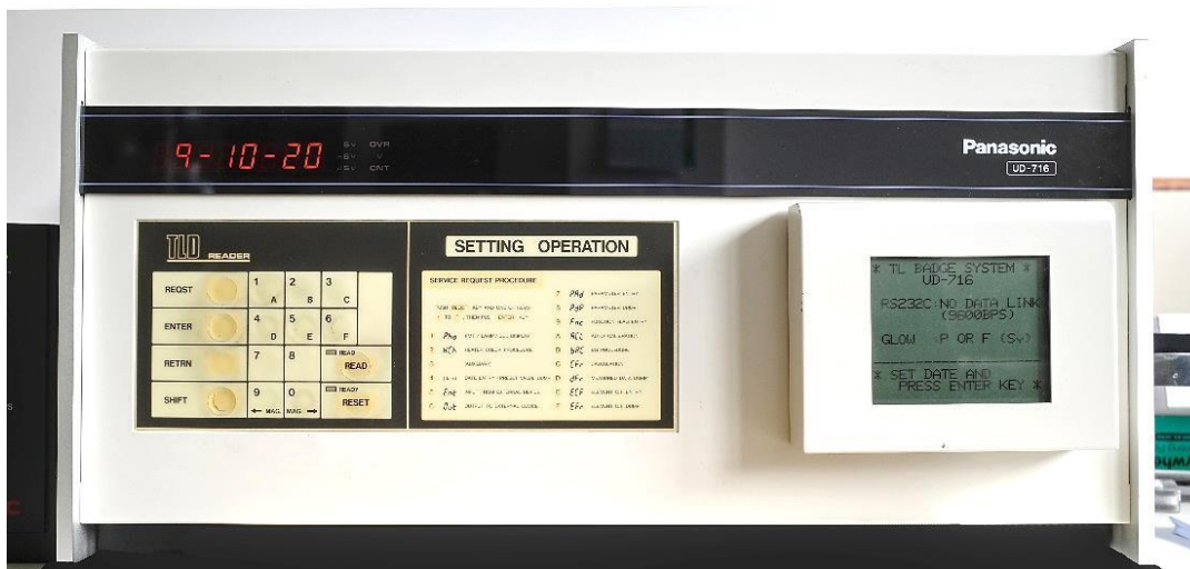
Slika 2.9: Čitač termoluminiscentnih dozimetara.
