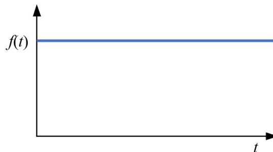
Slika 5.5: konstantna učestalost kvarova
