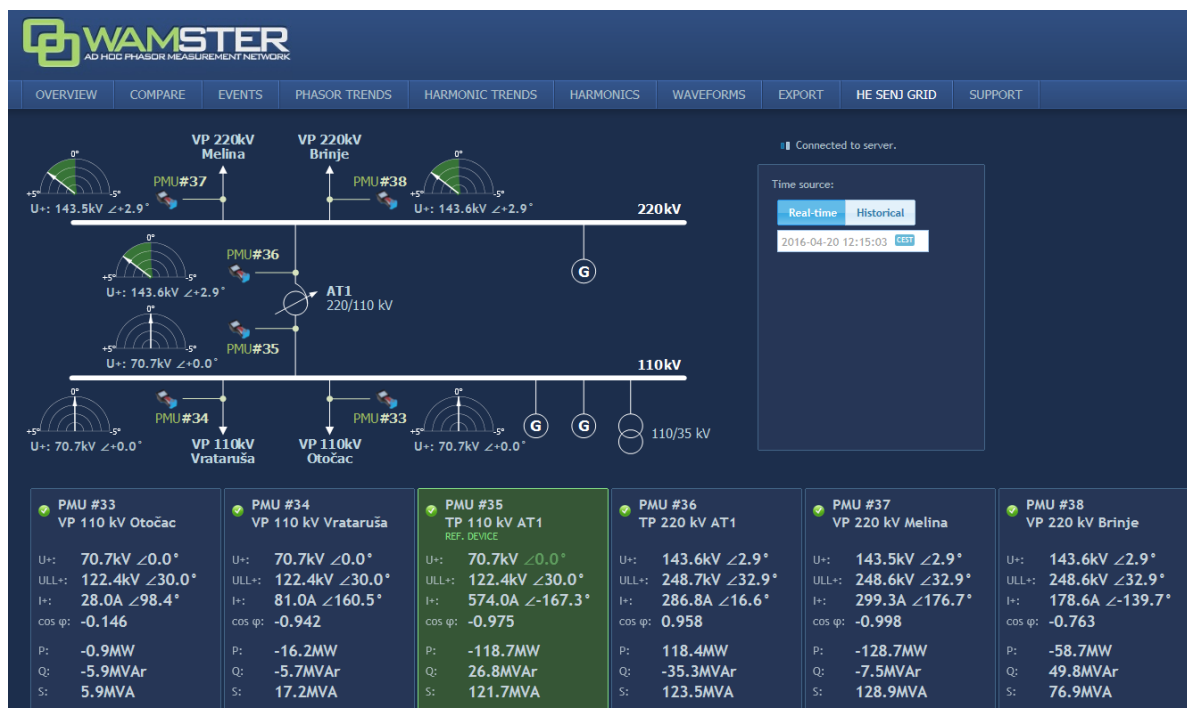
Slika 6.2 Stvarna sinkronizirana mjerenja snimljena korištenjem WAMSTER platforme
