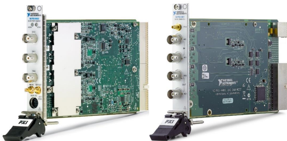
Slika 2.5 Izgled mjernih kartica NI PXI 5922 (lijevo) i NI PXI 4461 (desno)
