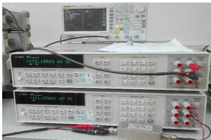
Slika 3.16 Mjerni instrumenti (vidi se RC filter) i funkcijski generator prilikom određivanja PCR-a strujnih shuntova
