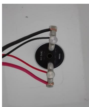
Slika 3.9 Etalonski otpornik unutar zračne komore
