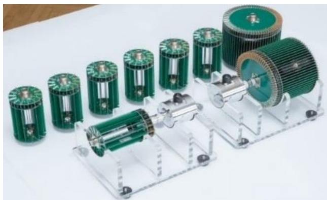
Slika 2.4 Kompletan set koaksijalnih shuntova [31]
