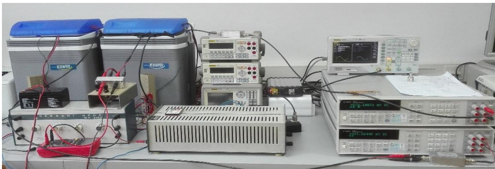
Slika 3.15 Mjerna oprema za određivanje PCR-a strujnih shuntova [31]
