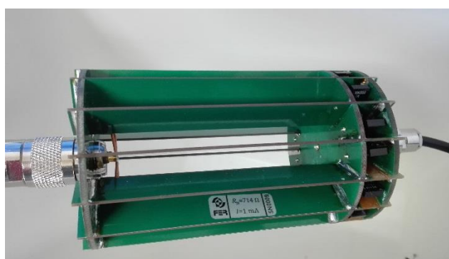
Slika 3.8 Mjereni strujni shunt unutar zračne komore
