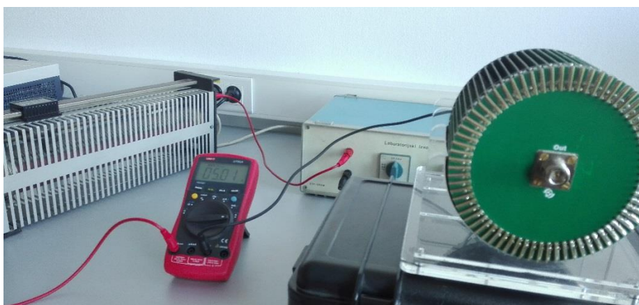
Slika 3.2 Mjerni strujni krug za praćenje temperature distribucije pomoću termičke kamere (za shuntove sa 70 rebara)
