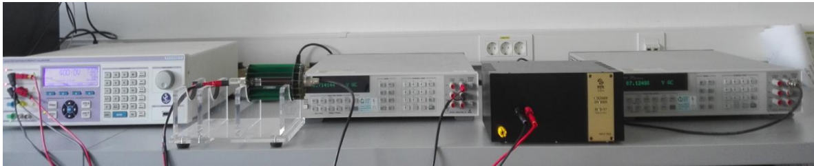
Slika 4.7 Laboratorijski mjerni postav za ispitivanje digitalnoga vatmetra [100]
