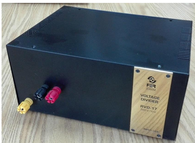
Slika 3.34 Otporničko naponsko djelilo 560/10 V [85]
