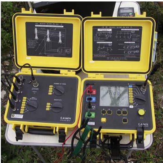
Slika 5.20: Mjerni uređaj i dodatak za mjerenje otpora uzemljivača stupa bez odspajanja zaštitnog vodiča
