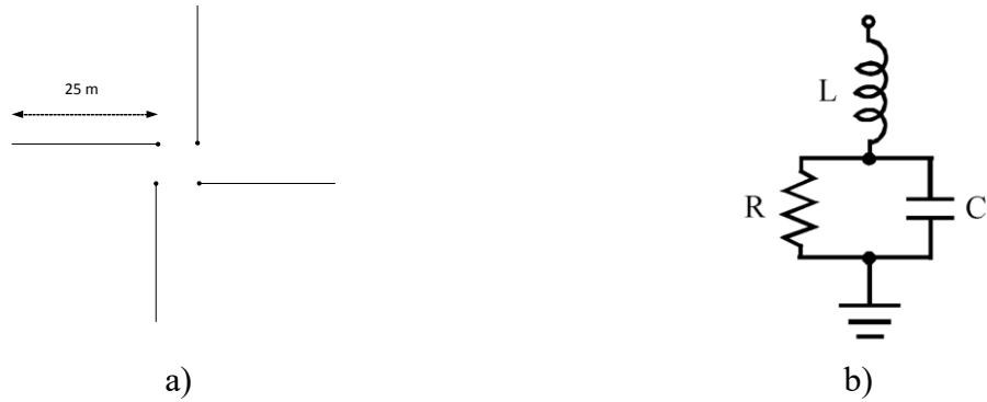
Slika 6.6: Konfiguracija uzemljivača stupa 4 x L (a) i nadomjesni model uzemljivača stupa (b)
