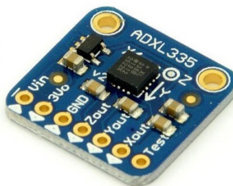
Slika 6.6: Akcelerometar ADXL335 koji je u mjerenjima korišten kao kontrolni detektor za vibracije
