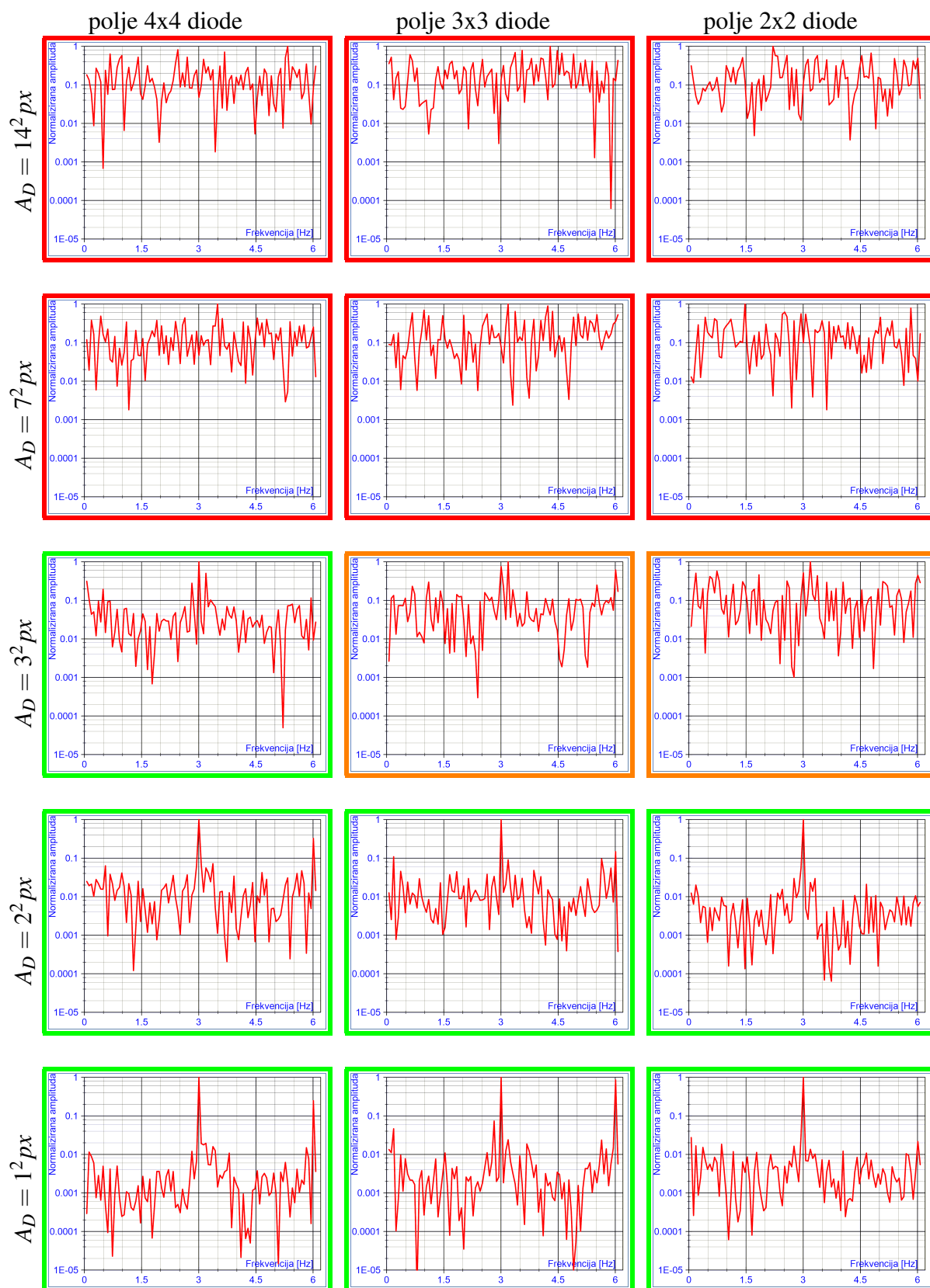
Slika 5.11: Usporedba različitih veličina detektorskih dioda metodom Mom. Ef
