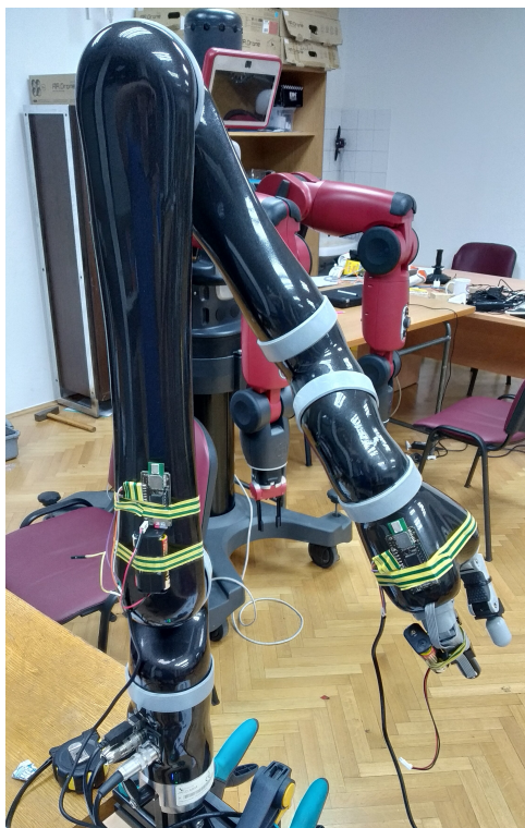
Slika 5.1: Mjerni postav temeljen na JACO robotskoj ruci i DW1000 prototipnim modulima
