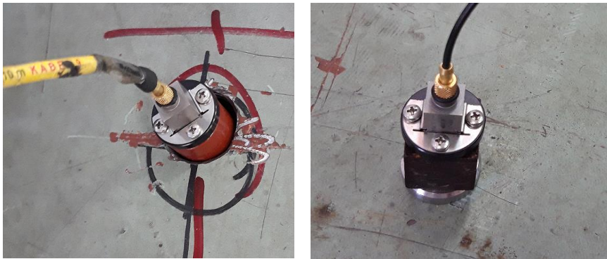
Slika 6.4 Akcelerometri spojeni na paket statora pomoću produljenog nosača kroz probušenu rupu plašta kućišta (lijevo) i na plašt kućišta upotrebom standardnog nosača (desno)
