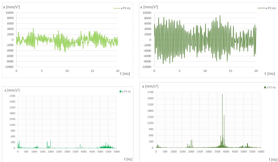
Slika 6.37 Izmjereni valni oblici akceleracija na mjestima P1 i P2 paketa statora pri nesimetričnom opterećenju U=400 V, S=52 kVA, \cos\varphi=1 uz faze B-C protjecane strujom
