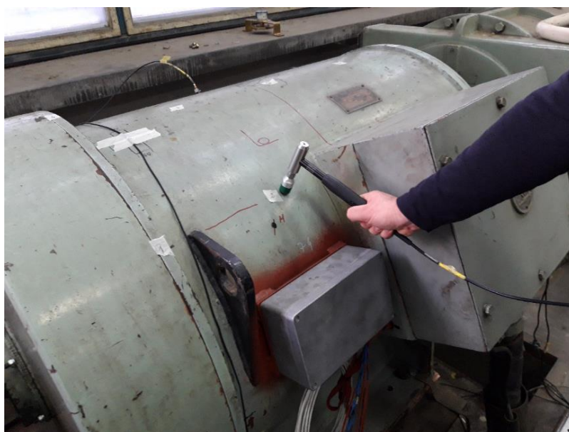
Slika 6.10 Stvaranje mehaničkog pobudnog impulsa udarcem čekića o kućište statora
