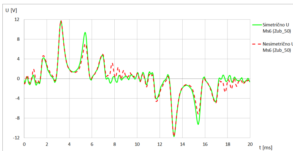
Slika 4.23 Napon mjernog svitka za simetrično i električki nesimetrično opterećenje
