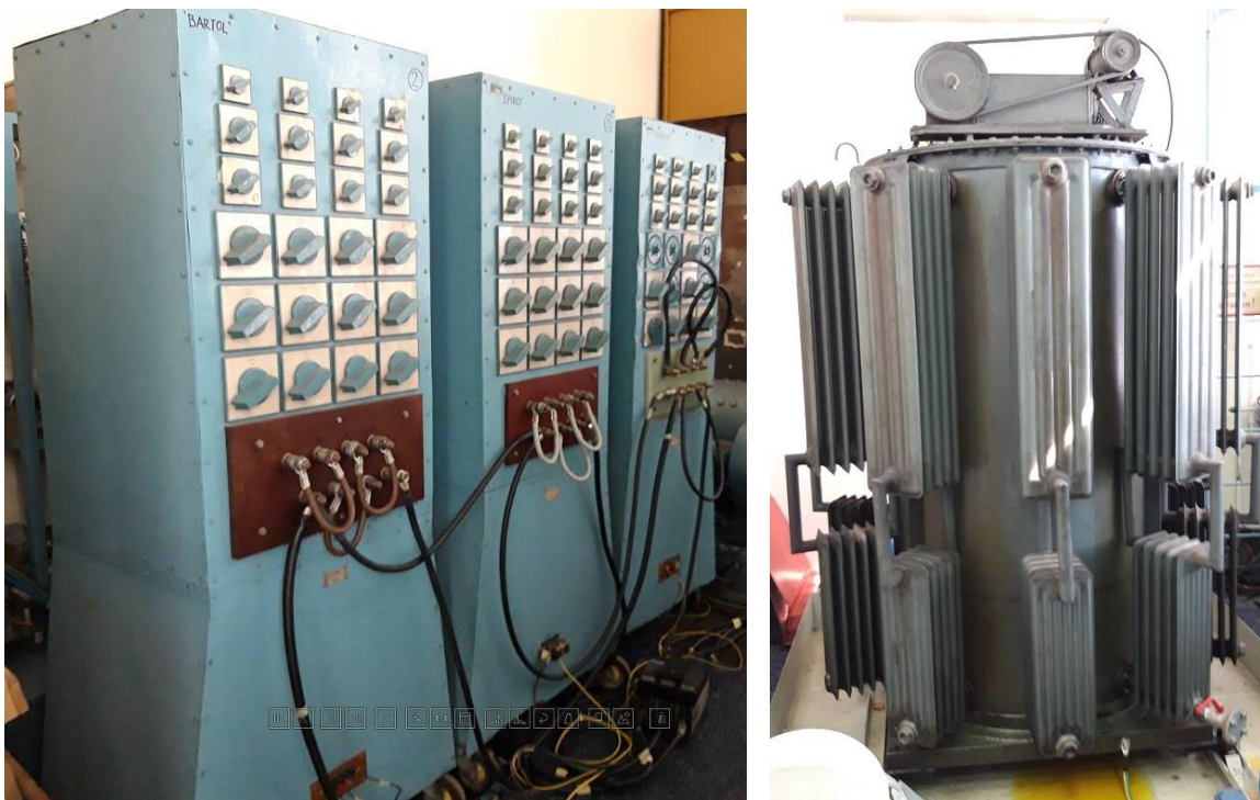
Slika 3.13 Kaskada otpornika (lijevo) i prigušnica promjenjivog induktiviteta (desno) korišteni za pasivno terećenje generatora
