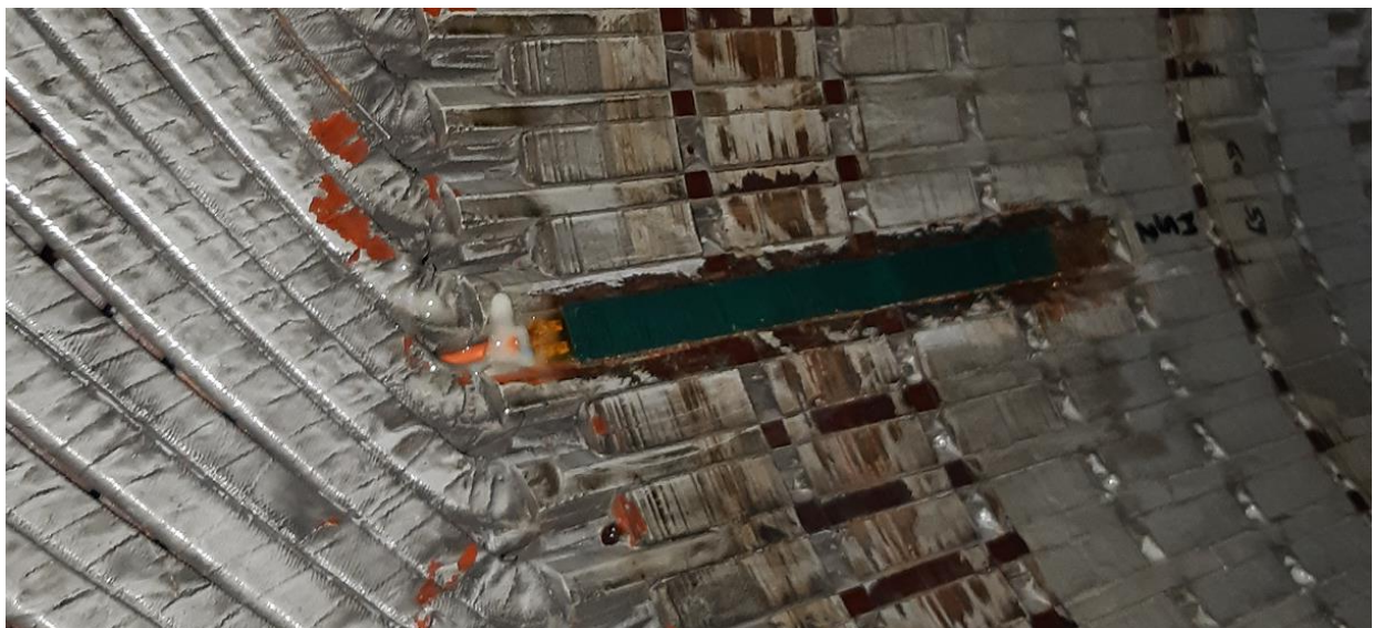
Slika 3.16 Mjerni svitak ugrađen na zub paketa statora
