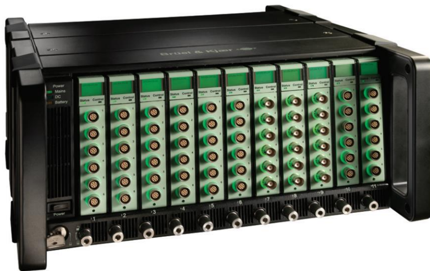
Slika 3.24 Mjerna stanica PULSE s LAN-XI procesnim modulima [40]
