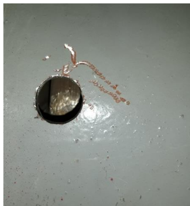
Slika 3.8 Provrta na kućištu ispod kojeg je dostupan paket statora za montažu senzora
