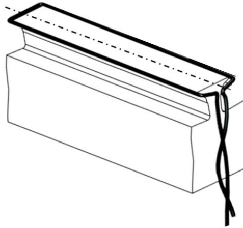
Slika 4.2 Način ugradnje svitka za mjerenje magnetskog polja na radijalnu plohu zuba paketa statora električnog stroja
