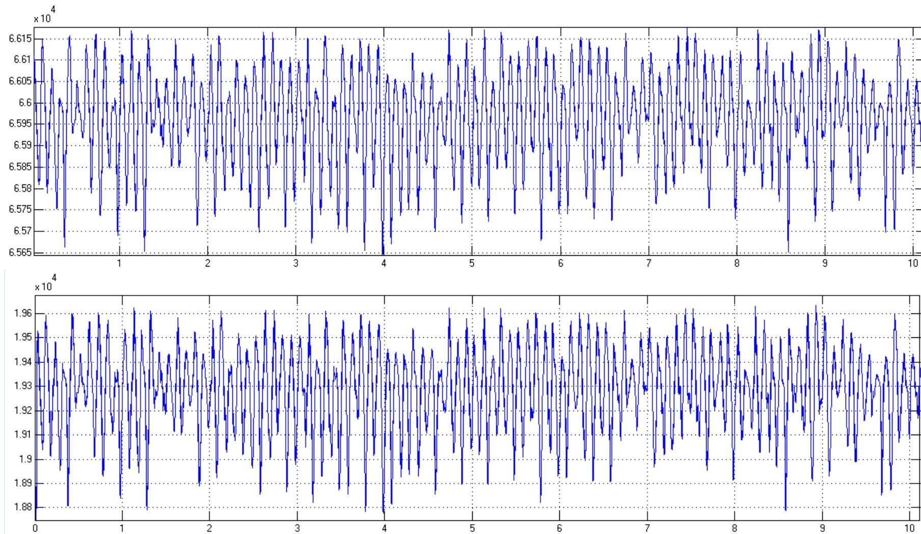
Slika 5.25. Gore: Efektivne vrijednosti napona faze A na 110 kV strani transformatora
