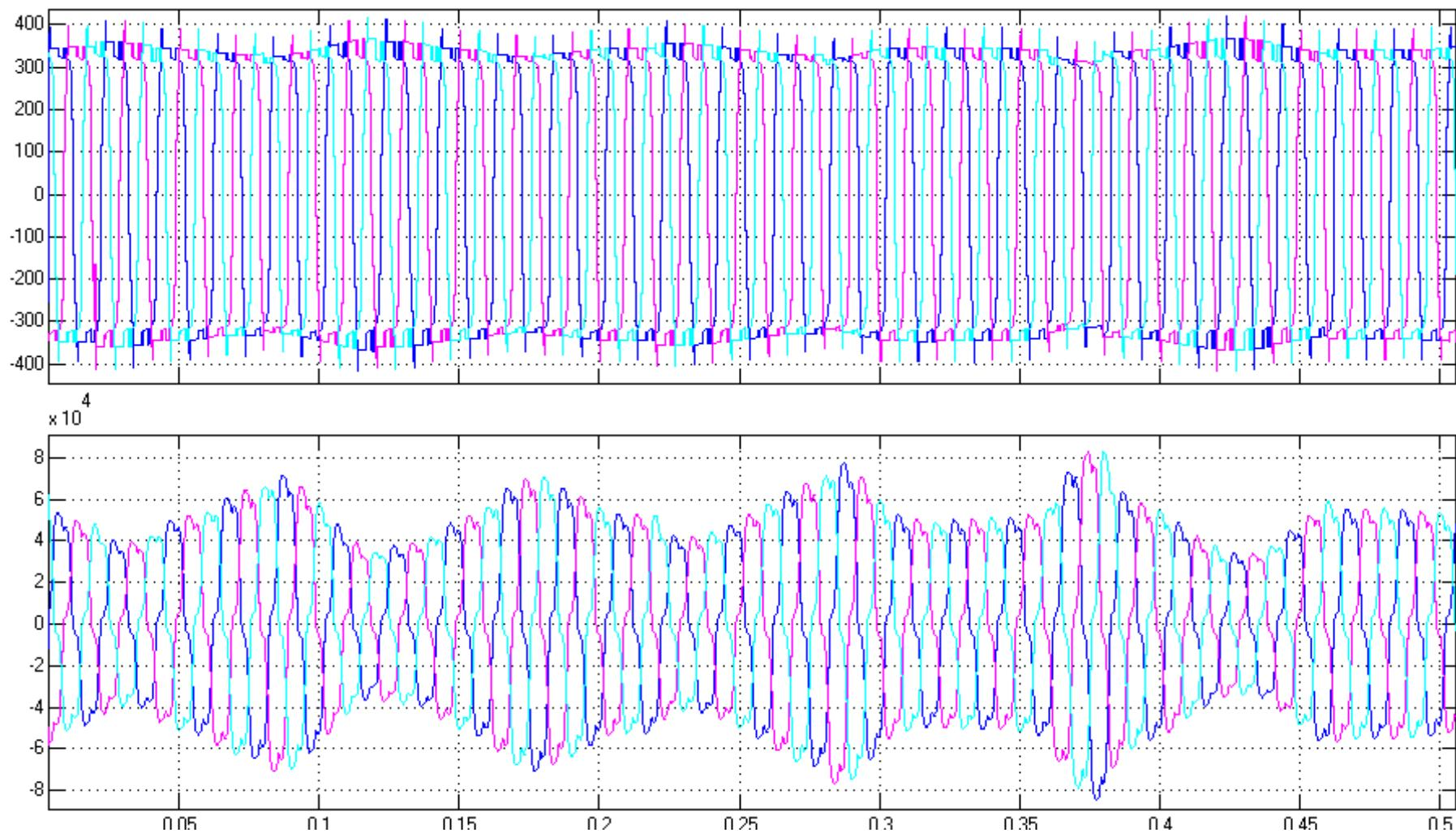
Slika 5.22. Gore: Vremenski prikaz faznih napona na 0,52 kV strani transformatora
