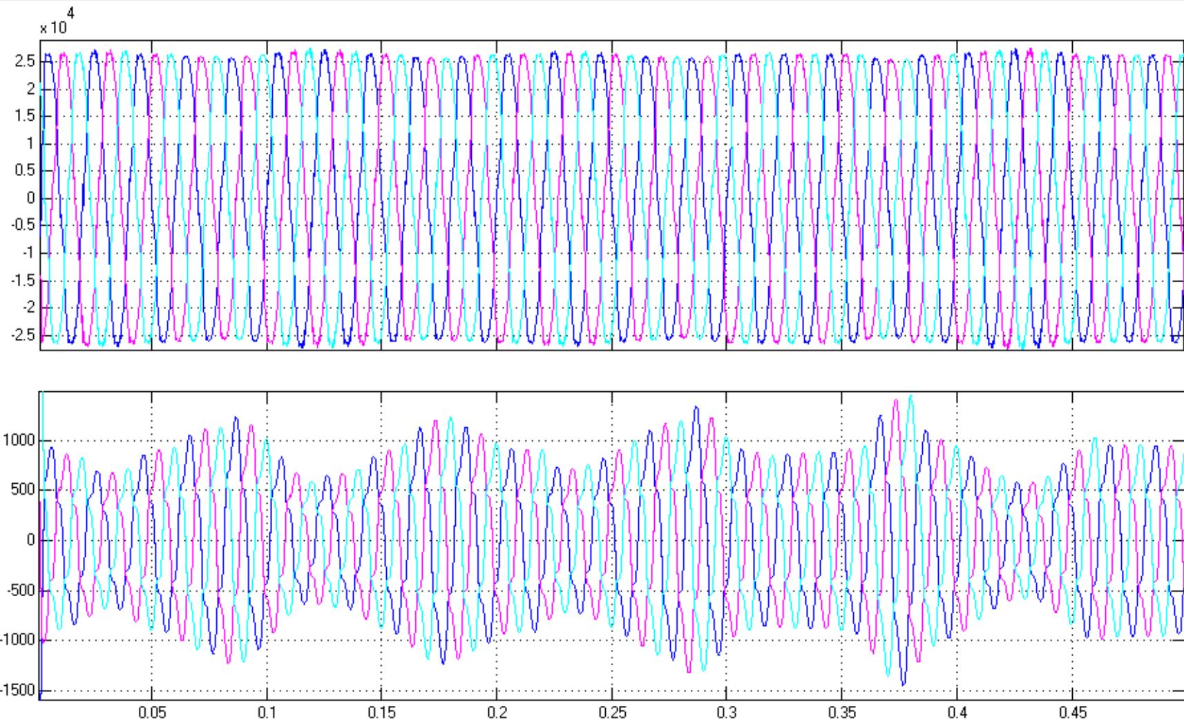
Slika 5.23. Gore: Vremenski prikaz faznih napona na 33 kV strani transformatora
