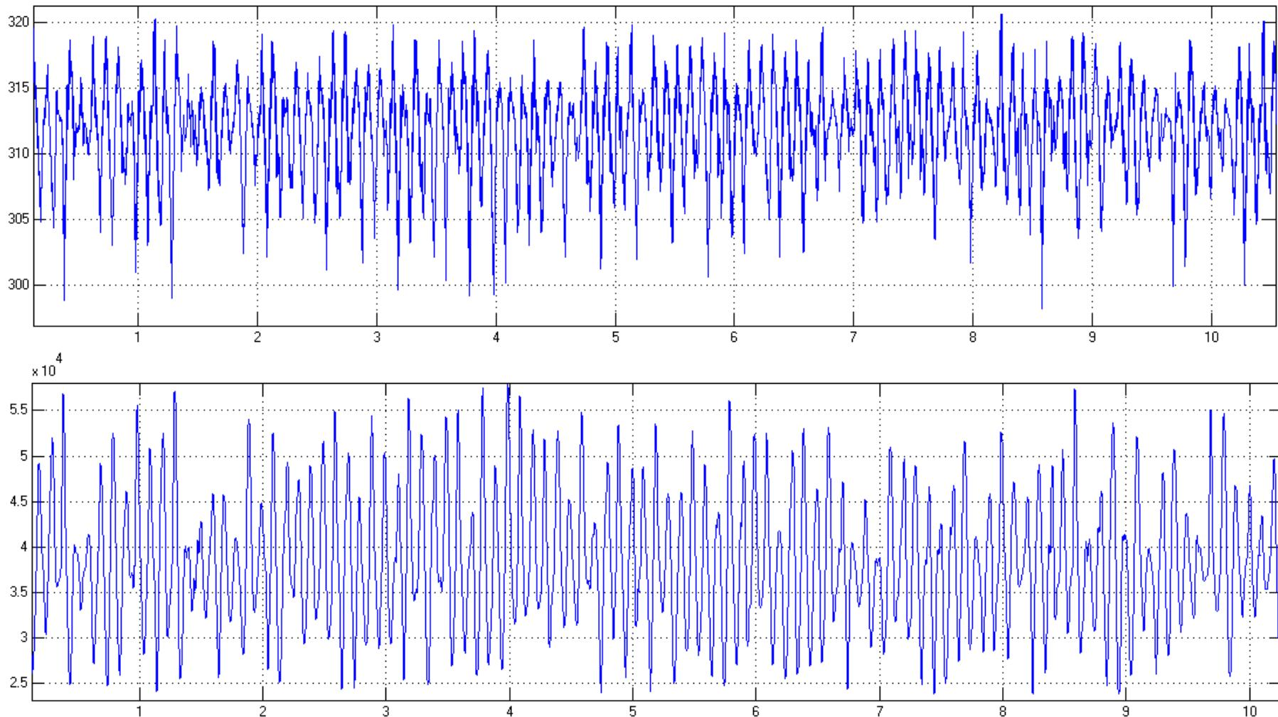
Slika 5.15 Gore: Efektivne vrijednosti napona faze A na 0,52 kV strani transformatora
