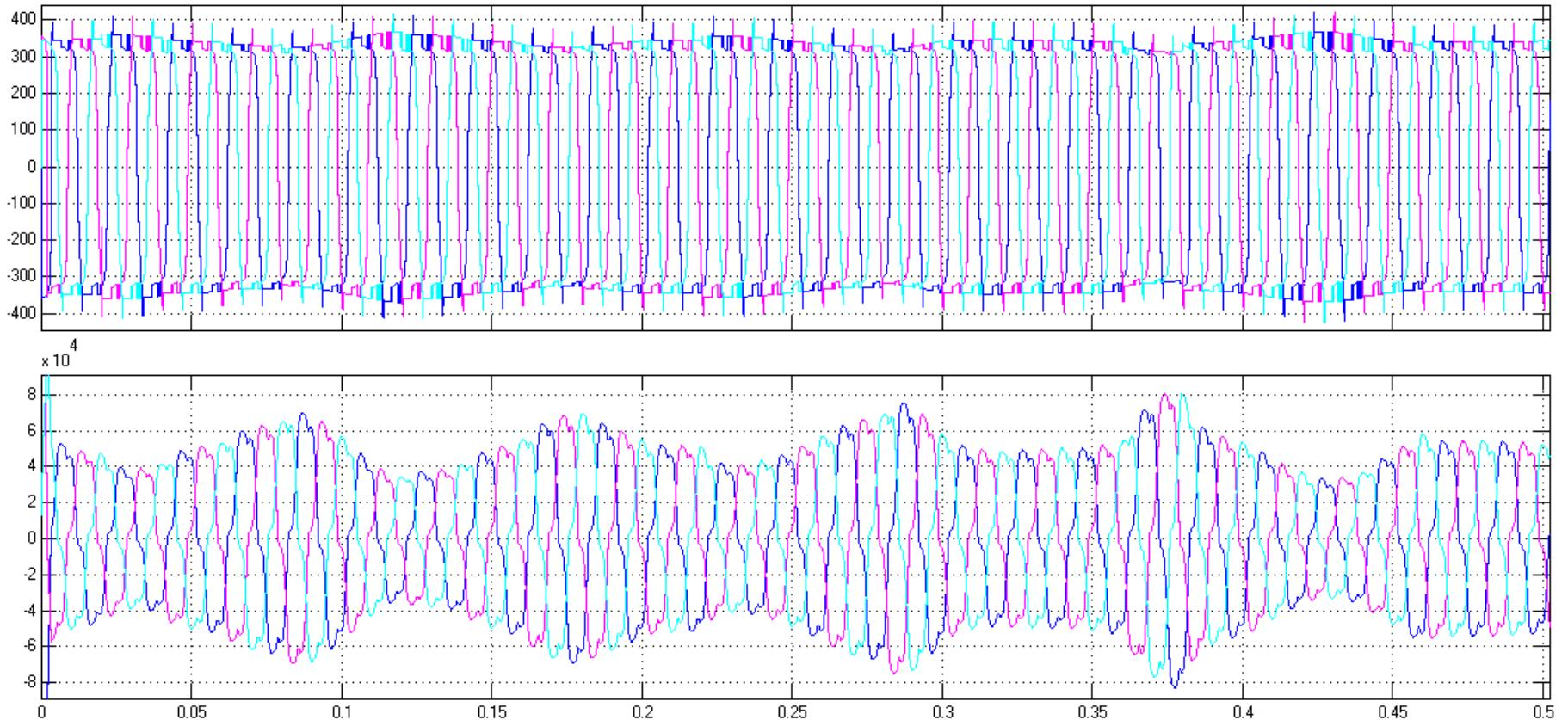
Slika 5.13 Gore: Vremenski prikaz faznih napona na 0,52 kV strani transformatora
