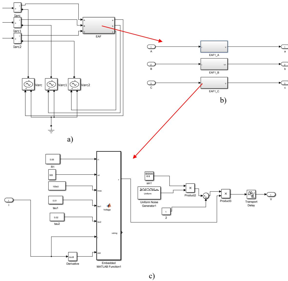
Slika 5.7. Detaljni prikaz simulacijskog modela elektrolučne peći – MATLAB (Simulink): a) Naponski izvori upravljeni strujnim signalima; b) model elektrolučne peći za faze A, B i C; c) prikaz detaljnog modela elektrolučne peći jedne faze
