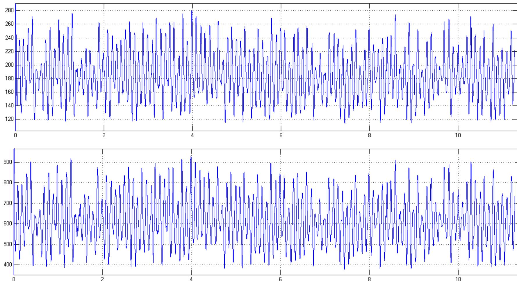
Slika 5.26. Gore: Efektivne vrijednosti struje faze A na 110 kV strani transformatora
