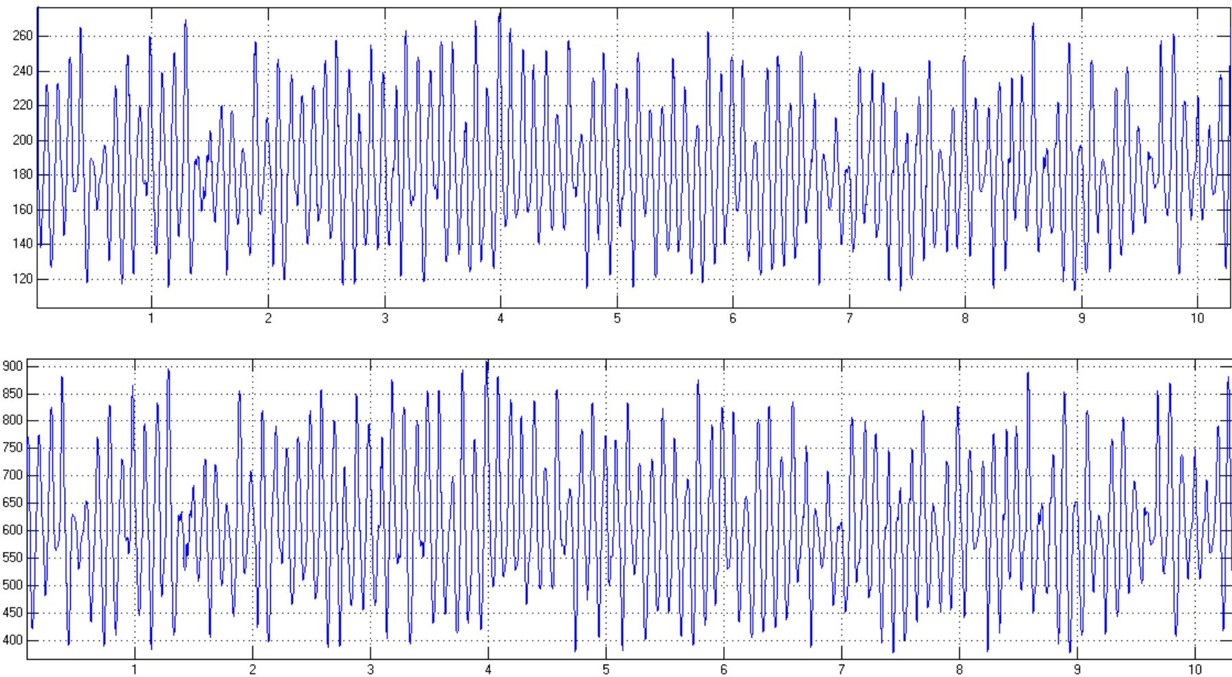
*Slika 5.17. Gore: Efektivne vrijednosti struje faze A na 110 kV strani transformatora
