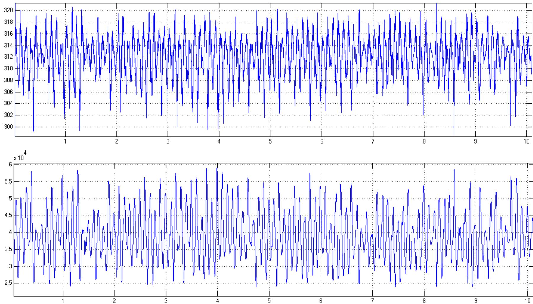
Slika 5.24. GORE: Efektivne vrijednosti napona faze A na 0,52 kV strani transformatora
