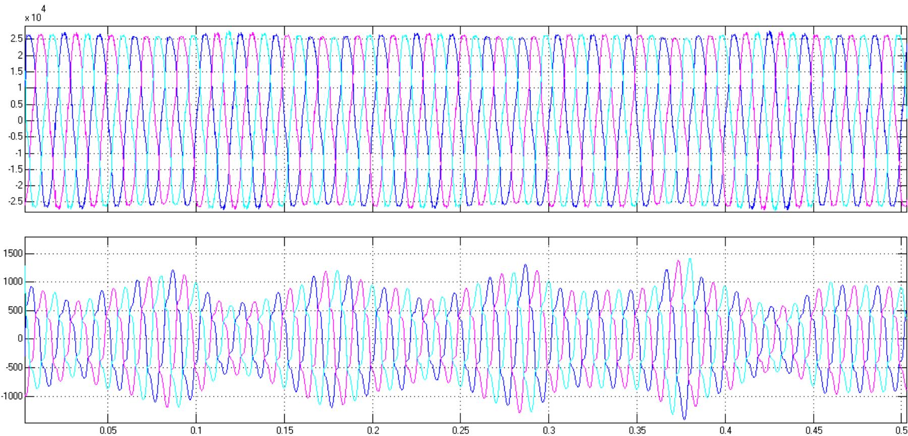
Slika 5.14 Gore: Vremenski prikaz faznih napona na 33 kV strani transformatora
