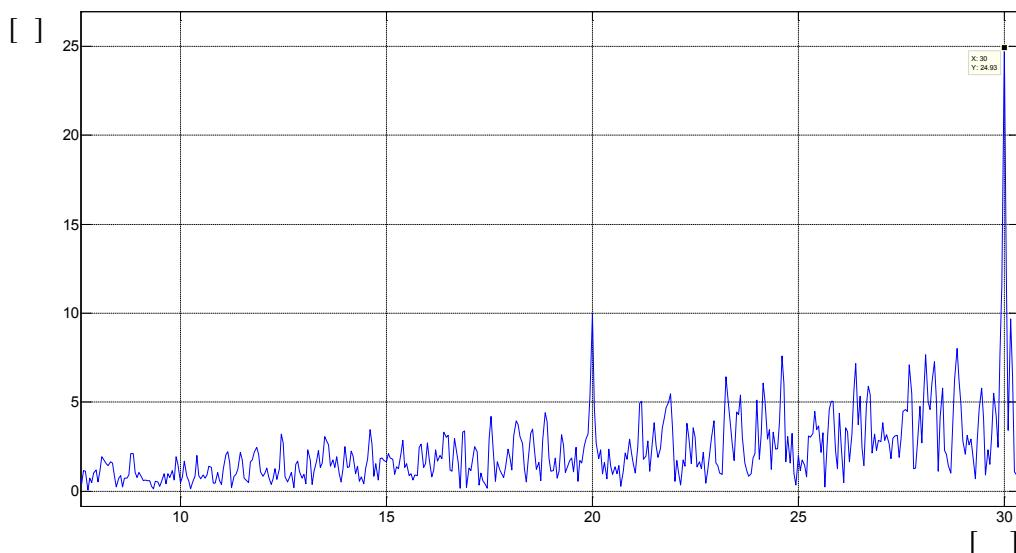
Slika 7.4. Amplituda napona po frekvencijama na 110 kV razini u TS Stanica 1
