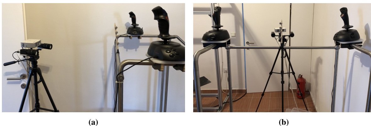
Slika 7.18: Vizijski sustav s dvije GigE Vision industrijske kamere: (a) pogled s bočne strane, (b) pogled sa stražnje strane
