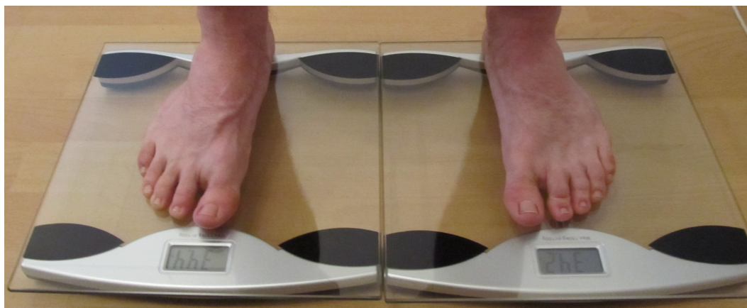
Slika 1.5: Mjerenje distribucije opterećenja nogu pomoću dviju jednakih komercijalnih vagi
