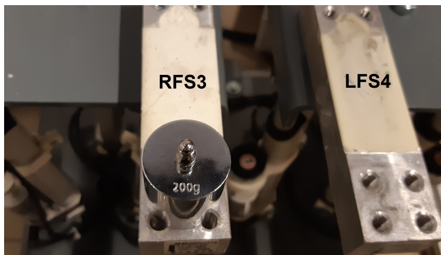
Slika 7.9: Postupak umjeravanja senzora sile s utegom mase 200 g
