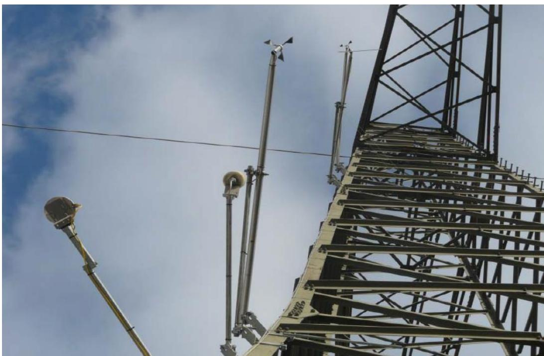
***Slika 2.13 Primjer meteorološke mjerne garniture na nadzemnim dalekovodima***
