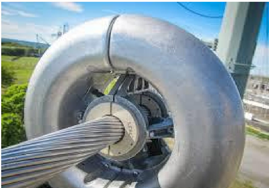
Slika 2.14 Prikaz tipičnog uređaja za mjerenje temperature vodiča (tzv. Power Donut)
