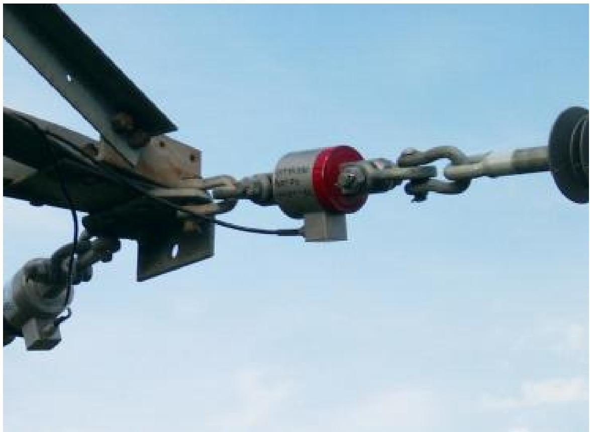
**Slika 2.20 Montaža sustava za mjerjenje naprezanja vodiča nadzemnog dalekovoda te pripadajuće ovjesne i spojne opreme**
