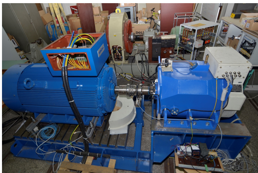
Slika 3.3: Sinkroni generator sa stalnim magnetima i asinkroni motor
