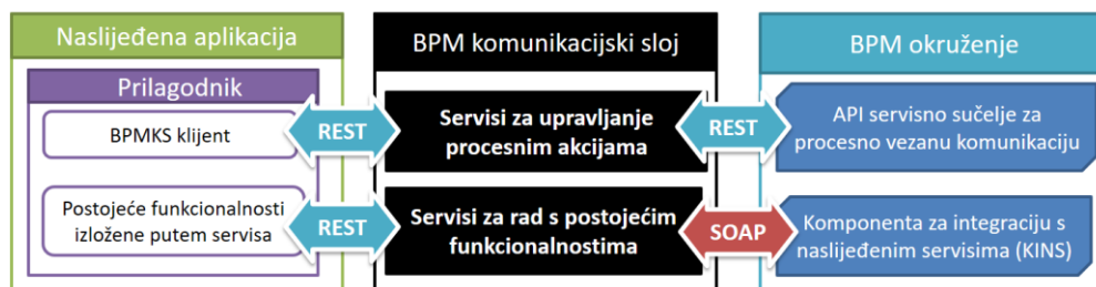
Slika 5.2 Korištene tehnologije komunikacije između komponenti
