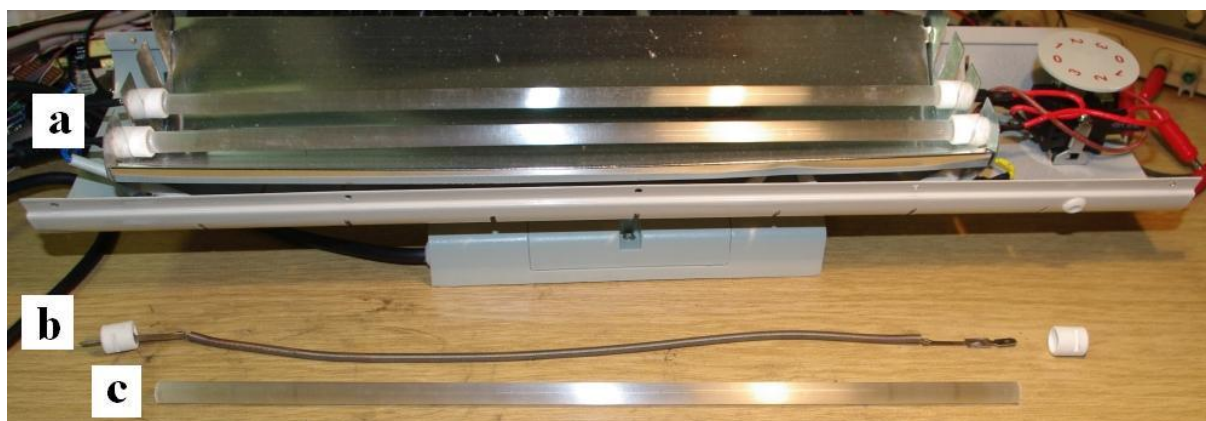
Slika 5.8. Rastavljena infracrvena grijalica: a) grijalica sa slike 5.7. bez zaštitnog poklopca otkriva njenu jednostavnu modularnu konstrukciju; b) grijač od otporne žice ima oblik dugačke zavojnice koja na oba kraja svršava „Fast-on“ spojnicama s keramičkim držačem; c) cijev od kvarcnog stakla služi kao nosač grijača i kao električna izolacija prema okolini.
