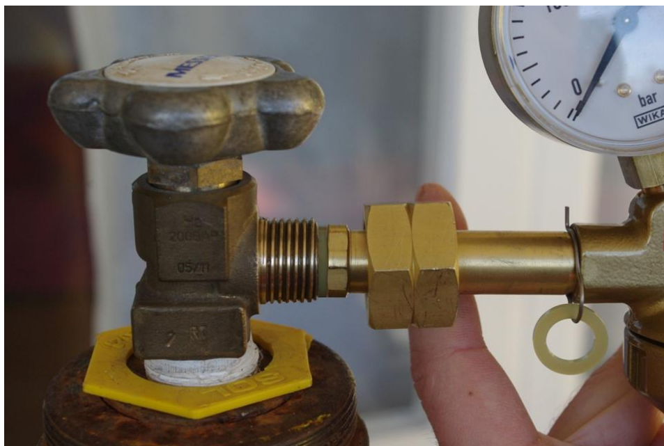
Slika 5.20. Instalacija vodika započinje pažljivim montiranjem reducirajućeg ventila s novom brtvom na čelični cilindar s komprimiranim plinom. Na slici desno vidljiva je rezervna brtva koja je uz pomoć metalne alke ovješena na reducirajući ventil.
