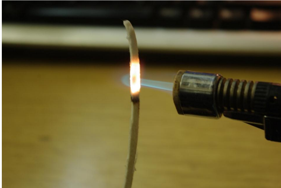
Slika 5.11. Testiranje stabilnosti keramičkog papira otvorenim plamenom. Materijal je prošao sve testove te se pokazao zadovoljavajućim za upotrebu na vrlo visokim temperaturama.
