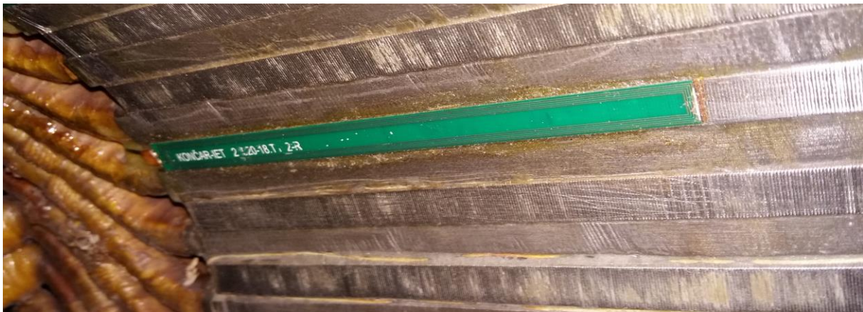
Slika 3.10 Mjerni svitak ugrađen na zub statora
