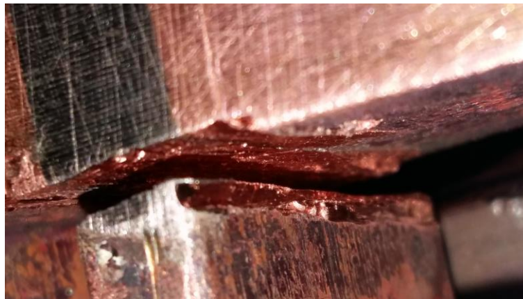
Slika 6.38 Mjesto na kaveznom namotu gdje je prekinut jedan štap rotora – područje tik uz prsten
