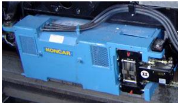
Slika 3.1 Tramvajski vučni motor
