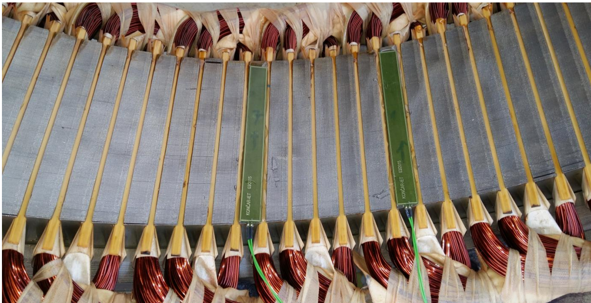
Slika 4.7 Mjerni svici za diferencijalno mjerenje magnetskog polja ugrađeni na zube statora asinkronog motora
