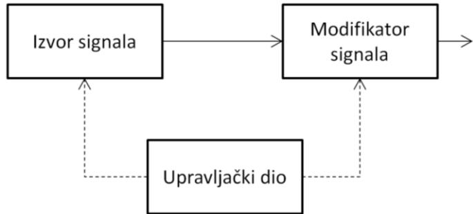
**Slika 2.3** Tok signala kod sintetizatora zvuka
