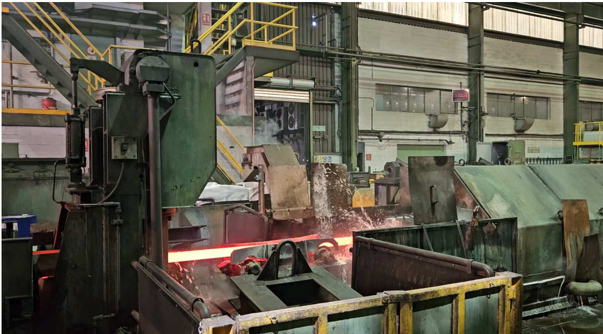
Slika 5.1. Ulaz materijala u valjačke stanove
