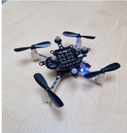
Slika 3.1. Crazyflie 2.1 s AI Deck-om i reflektivnim markerima
