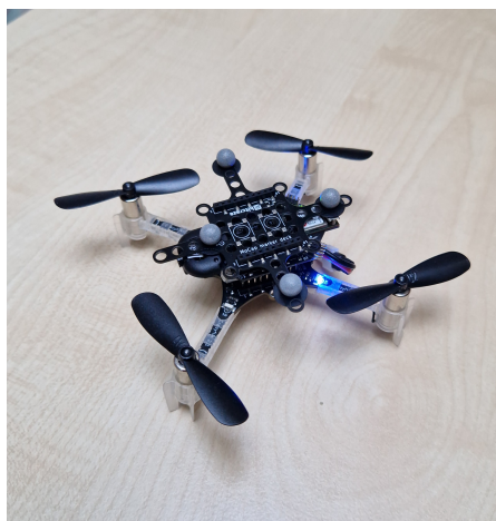
Slika 3.1. Crazyflie 2.1 s AI Deck-om i reflektivnim markerima
