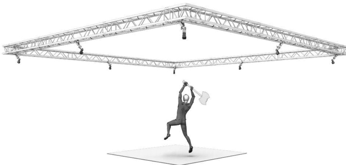
Slika 2.8. Raspored OptiTrack Flex 3 kamera s prikazom subjekta s retroreflektivnim markerima [52]
