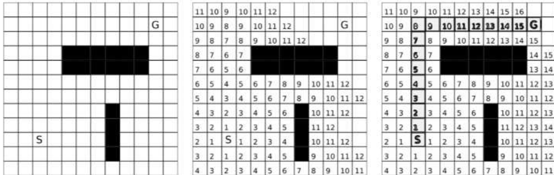
Slika 2.3. Dijkstrin algoritam pronalazi najkraći put od 'S' do 'G', pri čemu je trošak jednak jedan po svakoj ćeliji. Obratite pažnju na mali broj ćelija koje ostaju neistražene nakon što je najkraći put (sivi) pronađen, jer Dijkstra uvijek prvo razmatra ćeliju s najnižim troškom puta.[4]
