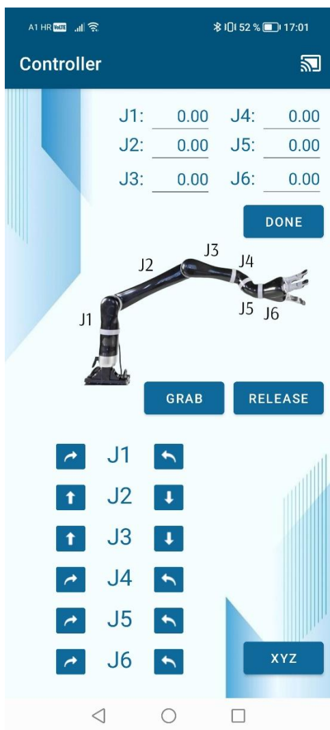
SI 2.3 Izgled aktivnosti kontrolera u koordinatnom sustavu robota
