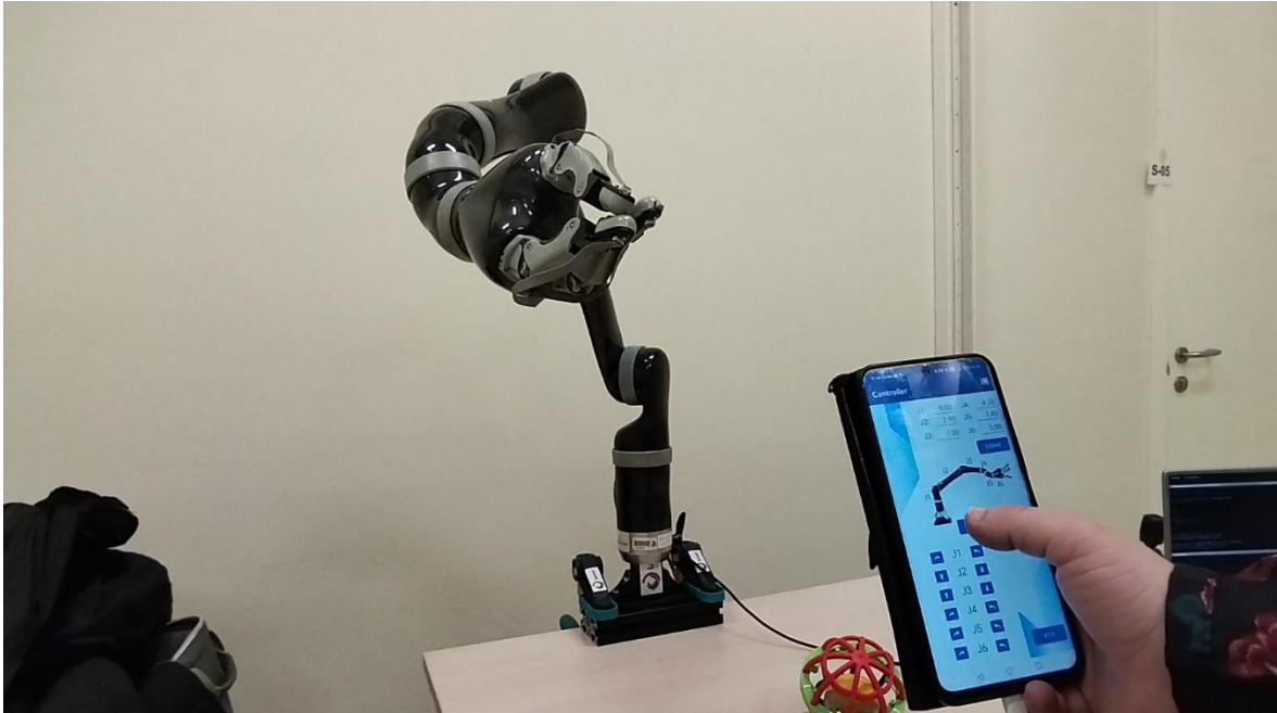
SI 4.11 Prikaz zatvaranja šake pritiskom na gumb grab
