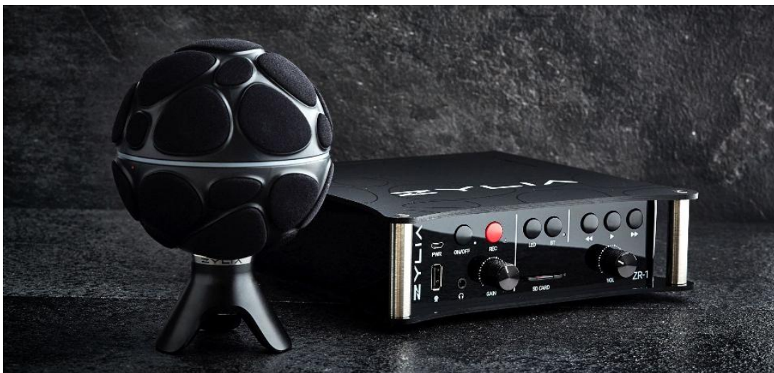
Slika 2.14: ZYLIA ZM-1 Ambisonics mikrofon uz Ambisonics snimač [76].
