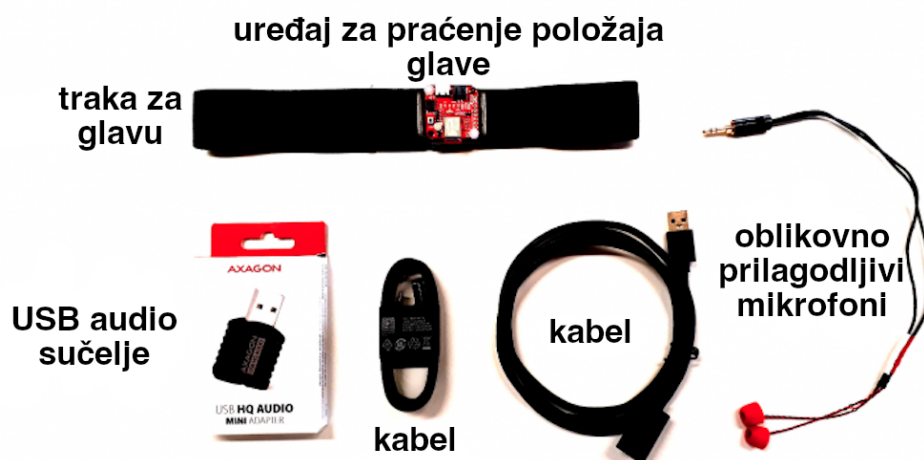
Slika 5.1: Oprema za izvođenje mjerenja individualnih HRTF skupova [134].
