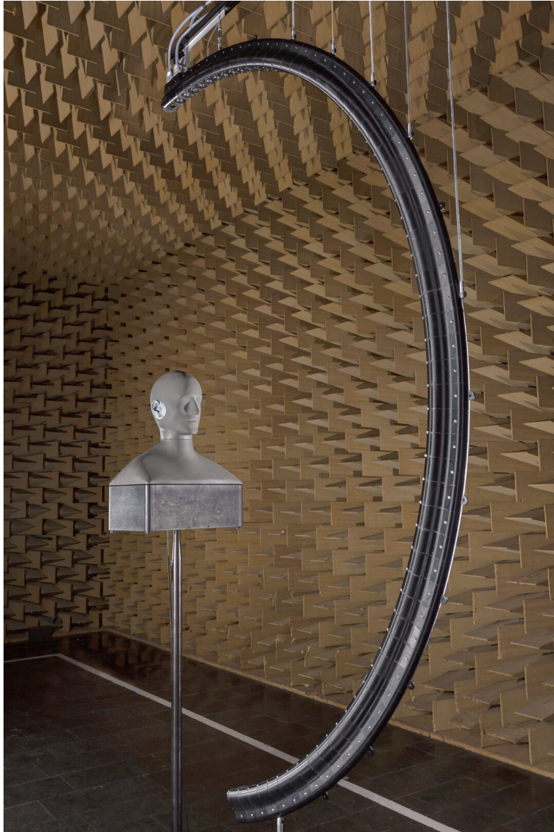
Slika 2.8: Prikaz mjerenja individualnih HRTF funkcija umjetne glave [46].
