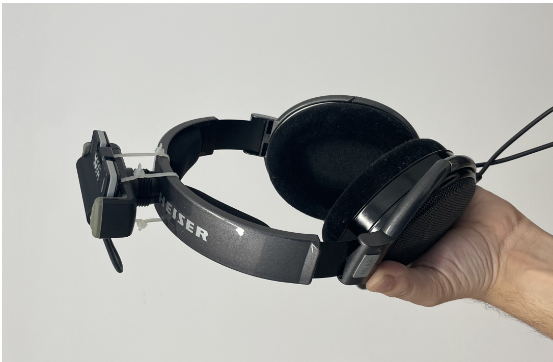
Slika 2.16: Waves NX [80] uređaj za praćenje položaja glave postavljen na slušalice binauralnog sustava.
