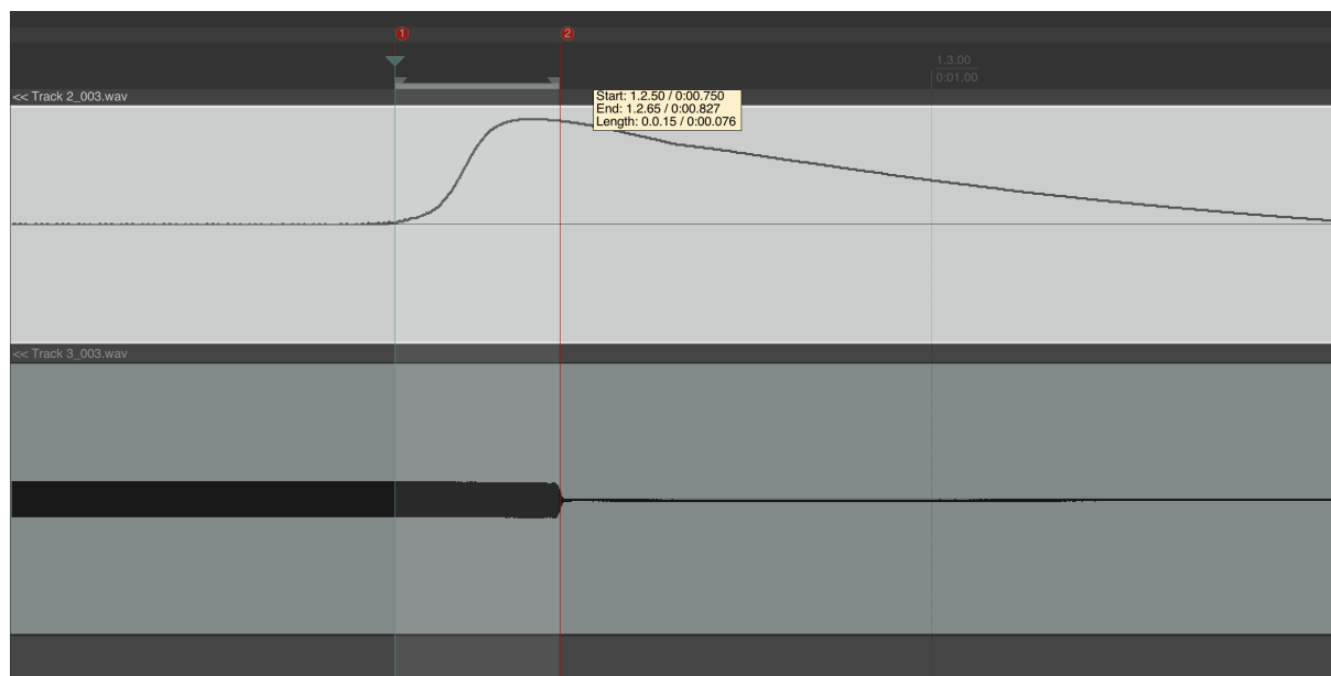
Slika 5.6: Mjerenje kašnjenja signala binauralnog sustava u Reaper DAW-u.
