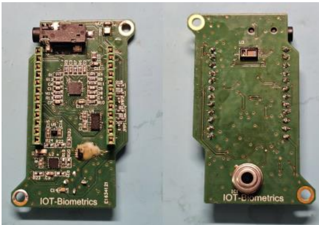
Slika 25. Ispočena pločica s postavljenim i zalemljenim komponentama, spremna za daljnju montažu i testiranje
