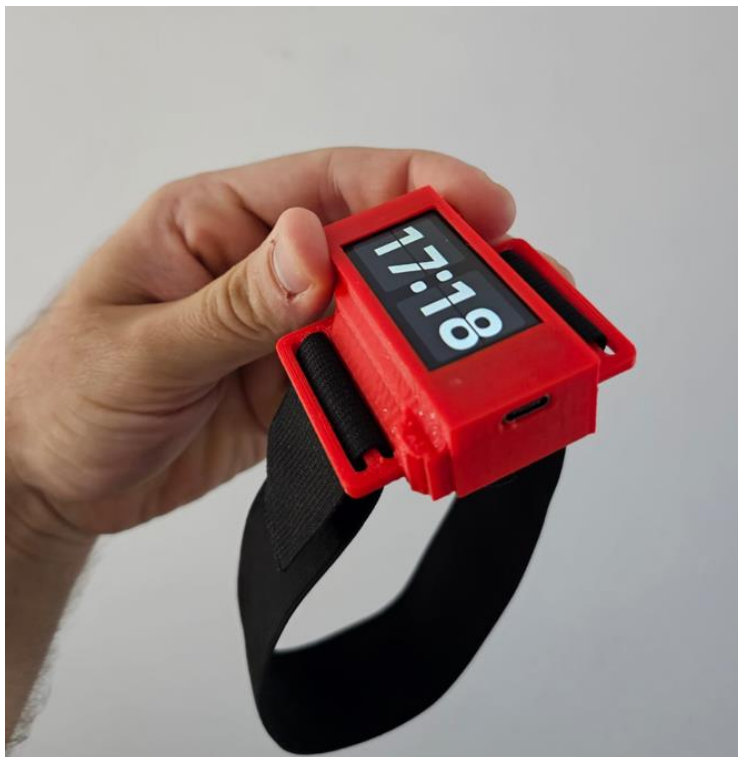
Slika 28. Isprintano 3D kućište s prostorom za ekran i otvore
