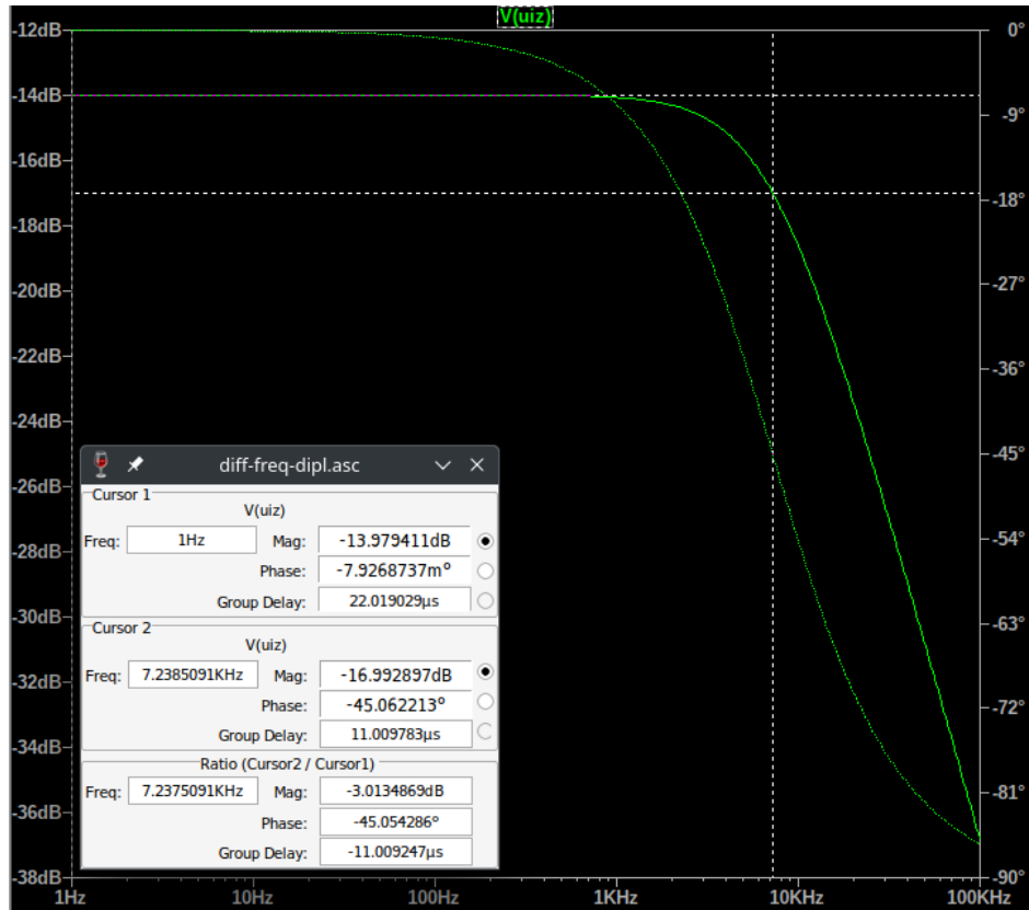
SI 2.2 Simulacija frekvencijskog odziv diferencijalnog pojačala
