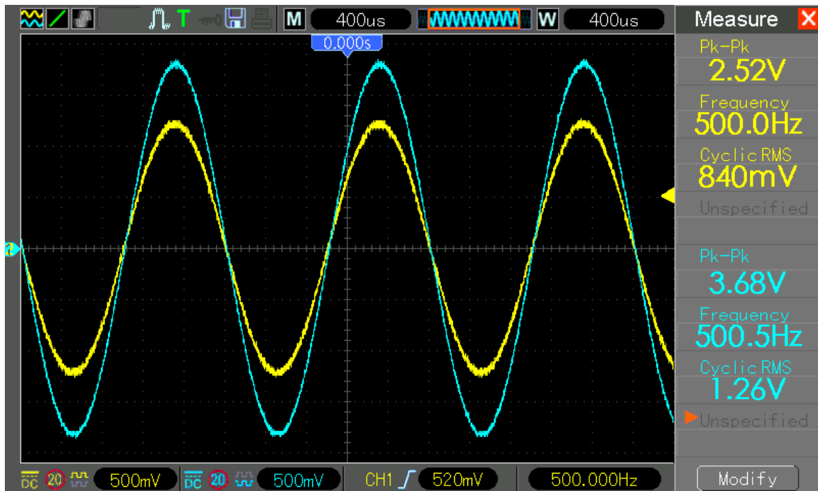
Slika 19 - Odnos signala na panorama regulatoru (žuto) i signala na izlazu sumirajućeg pojačala (plavo)
