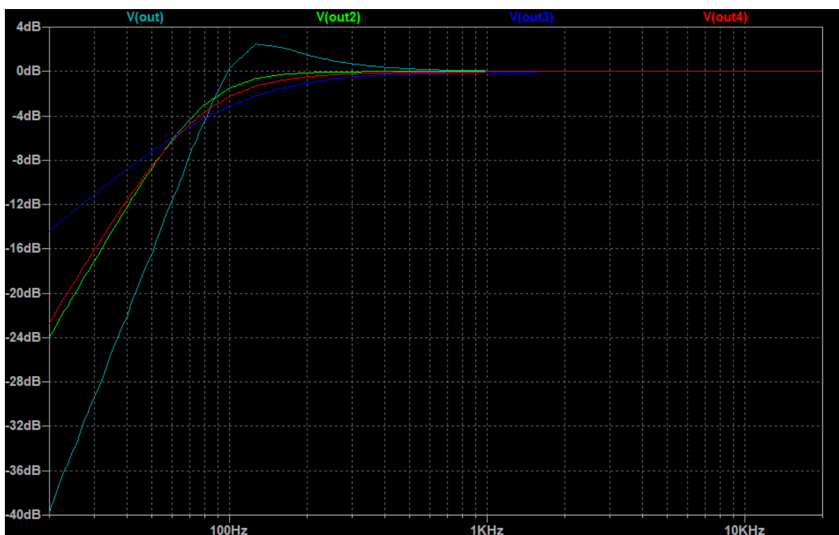
Slika 6 - Usporedba frekvencijskih karakteristika niskopropusnih filtara
