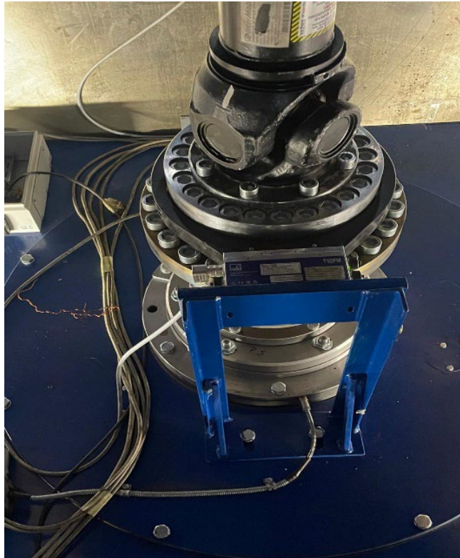
Slika 5.30: Instalirana mjerna osovina
