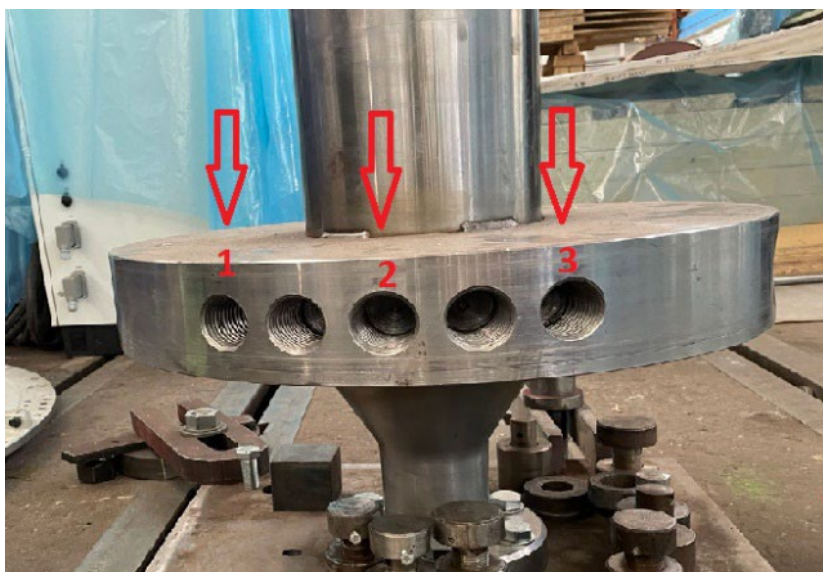
Slika 4.7: Položaji zakretanja osovine pri magnetiziranju rotora
