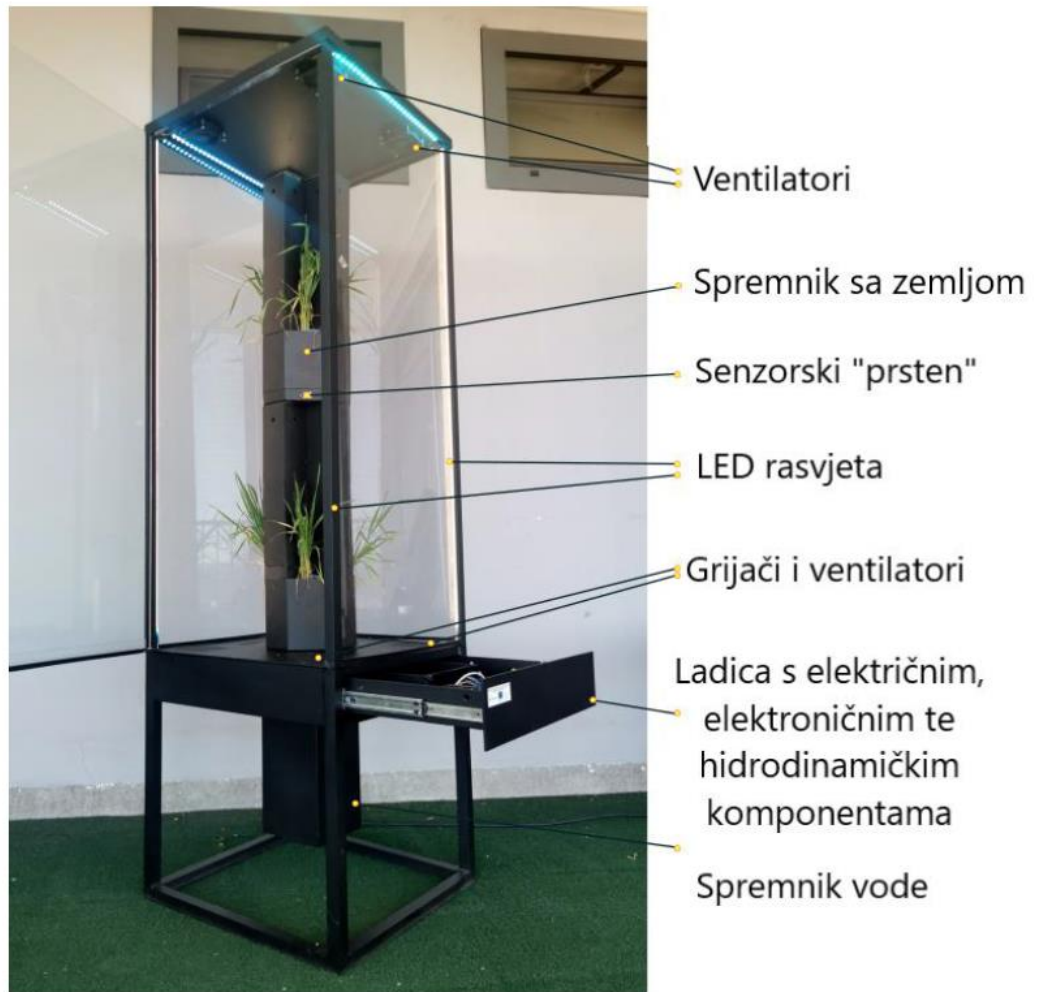
Sl. 1.2 Komora s glavnim pripadnim dijelovima [1]
