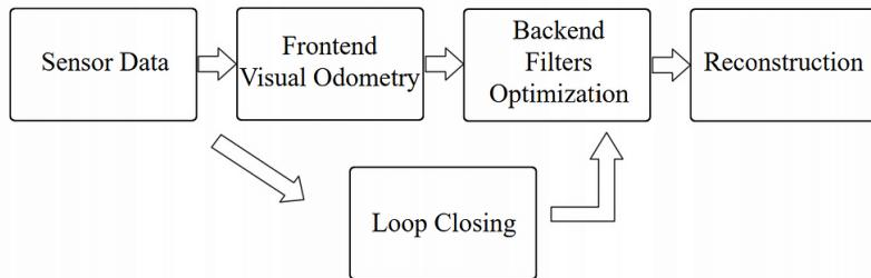
**Slika 2.2.** Tipičan SLAM cjevovod. Slika preuzeta iz [3].
