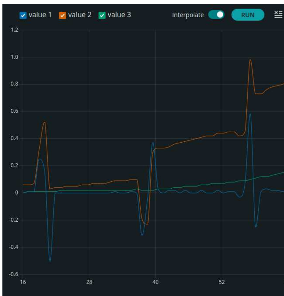
Slika 3.2. Drift uzrokovan dvostrukom integracijom
