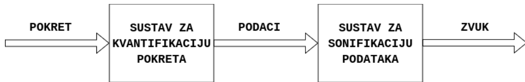
Slika 1.2. Model električnog instrumenta pogonjenog pokretom
