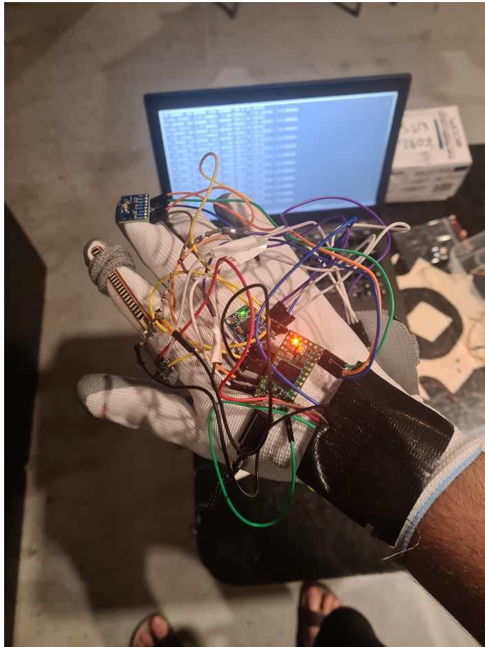
Slika 3.10. Ožičen i aktivan sustav na rukavici
