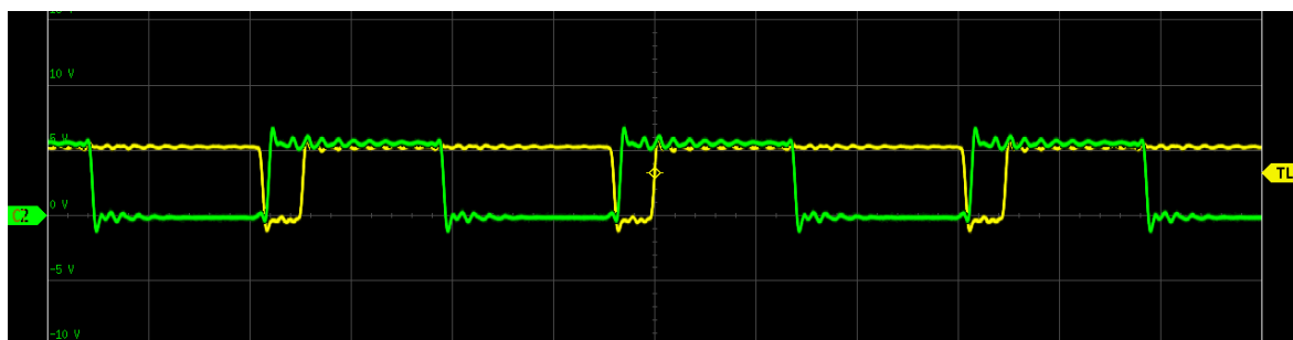
Slika 2.7 Oscilogram signala na izlazu U1C (zeleno) i U2A (žuto)
