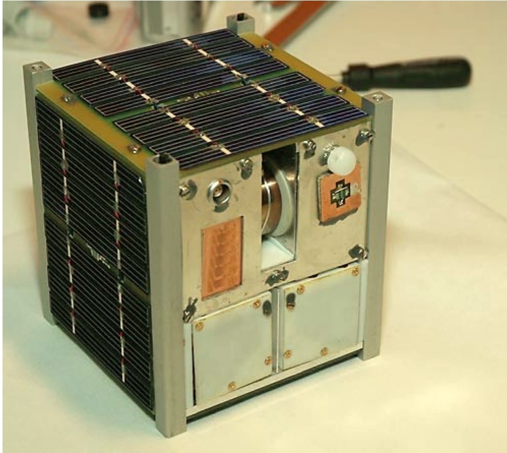
Slika 1.2. Fotonaponske ćelije na CubeSatu
