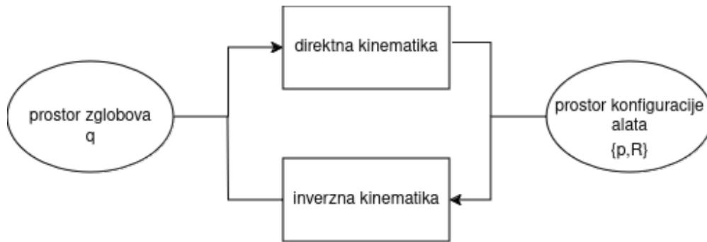
Slika 2.4. Direktna i inverzna kinematika
