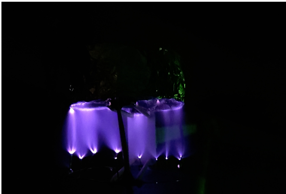
Slika 4.13: Ionski potisnik pri punom naponu rada
