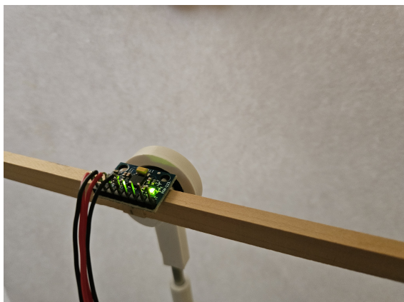
(c) Postavljen akcelerometar
